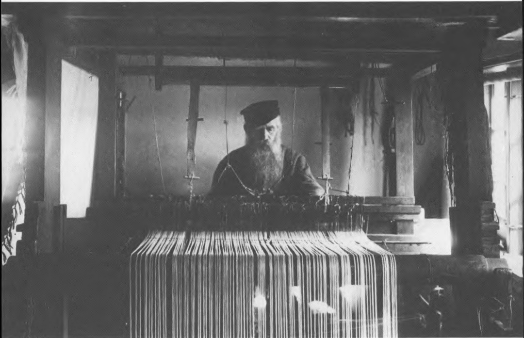
Sidst i 1800-årene fik erhvervsvæverne øget betydning, og de trængte gradvis hjemmevævningen i defensiven. Her er Jens »Donnerwetter« Christensen i Klosteret i Flensborg fotograferet ved væven, formentlig omkring år 1900. Man ser tydeligt kædetrådene i tøjets længderetning og øverst skafterne med de såkaldte søller. Fot. Th. Thomsen, Flensborg. Dansk Centralbibliotek for Sydslesvig.
