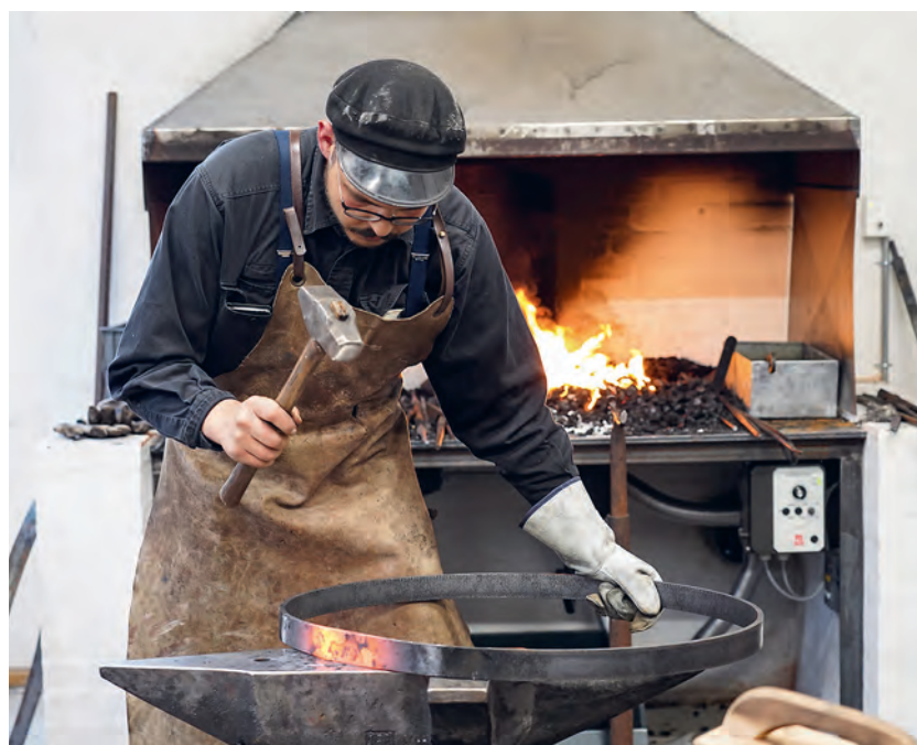
Smeden Johannes lægger sidste hånd på en jernring, inden den monteres på træhjulet.
