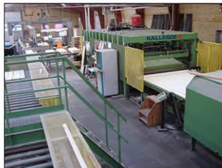
Presse 4 med presseplan på 6 x 2,1 m.
