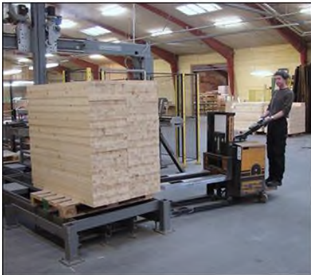
Portalstabler efter presse 4
