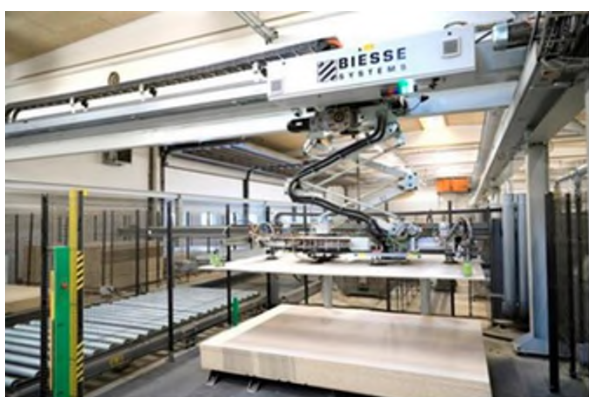
Biesse kran løfter plade ind på fuldautomatisk pladelager
