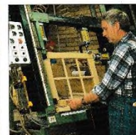
Samling foregår i fikturer og med fagligt uddannede håndværkere, som sikrer ensartet kvalitet.
