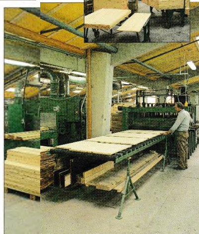
Indgæng og sortering af stave til sludring foregår manuelt. Dette sikrer nøjagtig den illet som er bestilt. Lamineret foregår i dampovnen, sømmelempresse efterfulgt af rugning, som sikrer emnerne en ensartet tykkelse.
