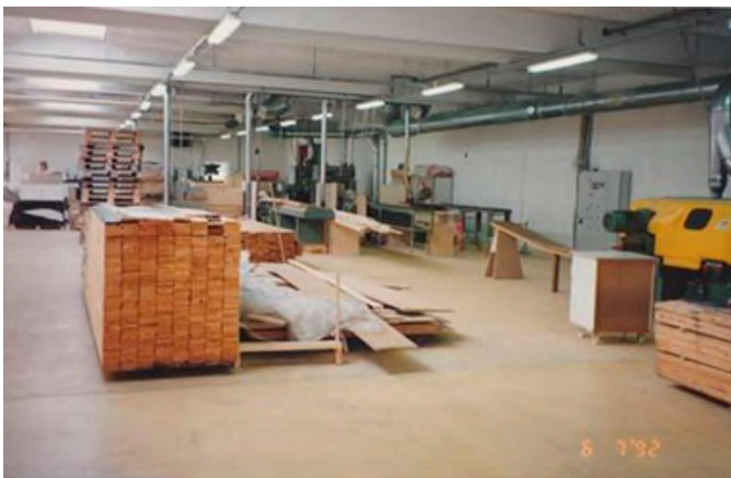
Maskinhal med kehlere og 3 kapsave. Skuffeproduktion
