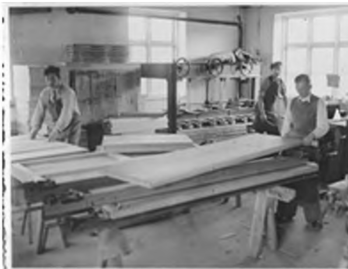
Limer kantlister med dørtvinge. Finerpresse i baggrunden
