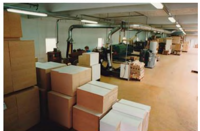
Maskingade: Dobbelttapper->dobbeltsidet kantlimer->boremaskine
