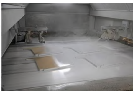
Travers lakering med hvid grunder
