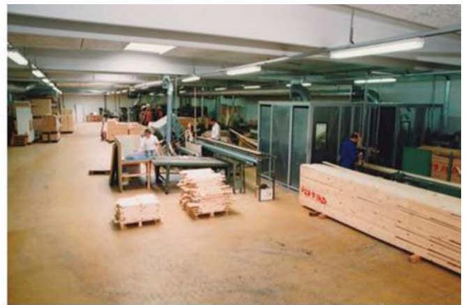
Maskinhal med 2 kehlere i bulderhus og optikapper.
