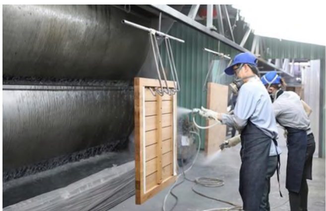
Fotos hal 1: Alle træemner sprøjtebehandles. Der arbejdes med bejdser, lakker og olier efter kundens ønske. Tredjepartsinspektion fra eksterne partnere og et internt team sikrer høj kvalitet
