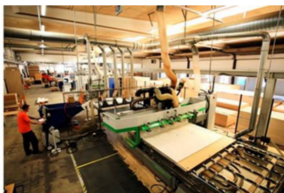
CNC der bliver betjent fra det fuldautomatiske pladelager
