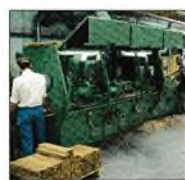
3 sprokkelte tekniskmaskiner sikrer en effektiv opretning og profilering med hydroplanter i varsløst.
