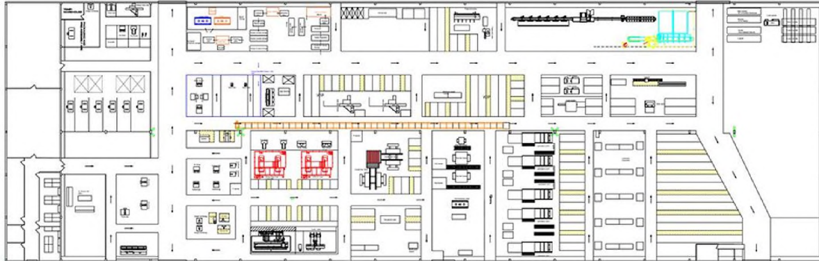
Opskæring råtræ, laminering, boring og støbning. Prøveværksted og testlaboratorium.
