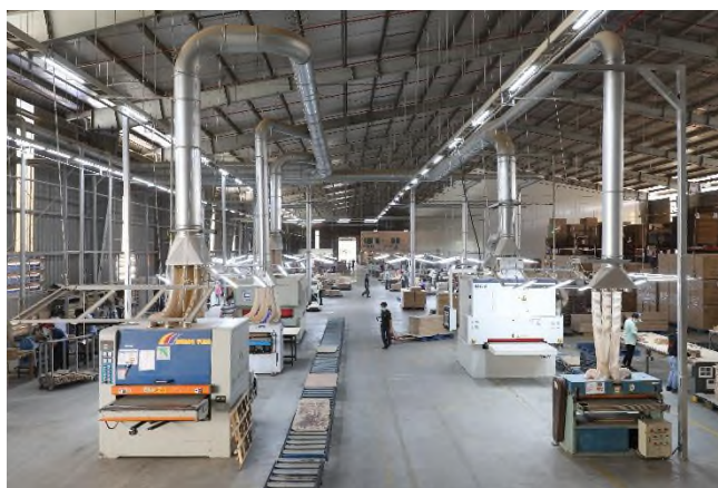
Hal 2: Finerede emner pudses på særligt kalibrerede bredbåndspudserne.
