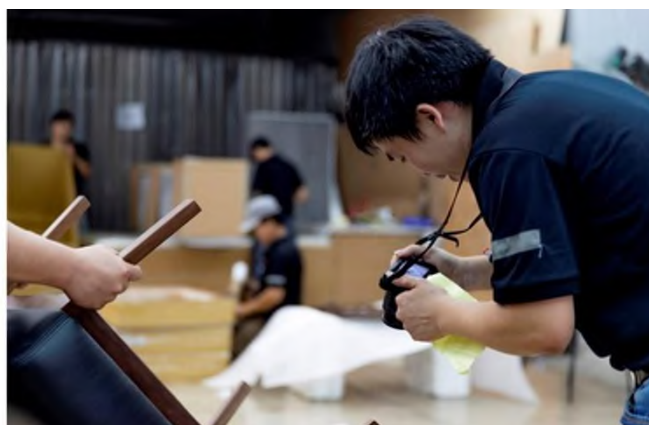
Fotos hal 1: Alle træemner sprøjtebehandles. Der arbejdes med bejdser, lakker og olier efter kundens ønske. Tredjepartsinspektion fra eksterne partnere og et internt team sikrer høj kvalitet
