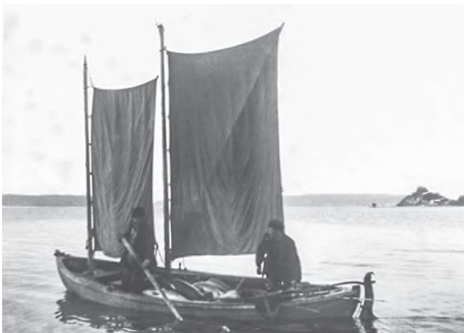
En jolle med 2 smakker, smakke betyder, at sejlet holdes oppe med skråstager, dvs. der er ingen vandret bom.
