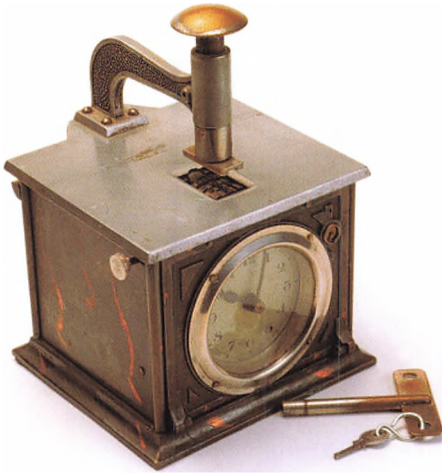
Stempelur. Brugt på vagtcentralen ca. 1927-1950 til at stemple klokkeslet på køresedler til dokumentation.
