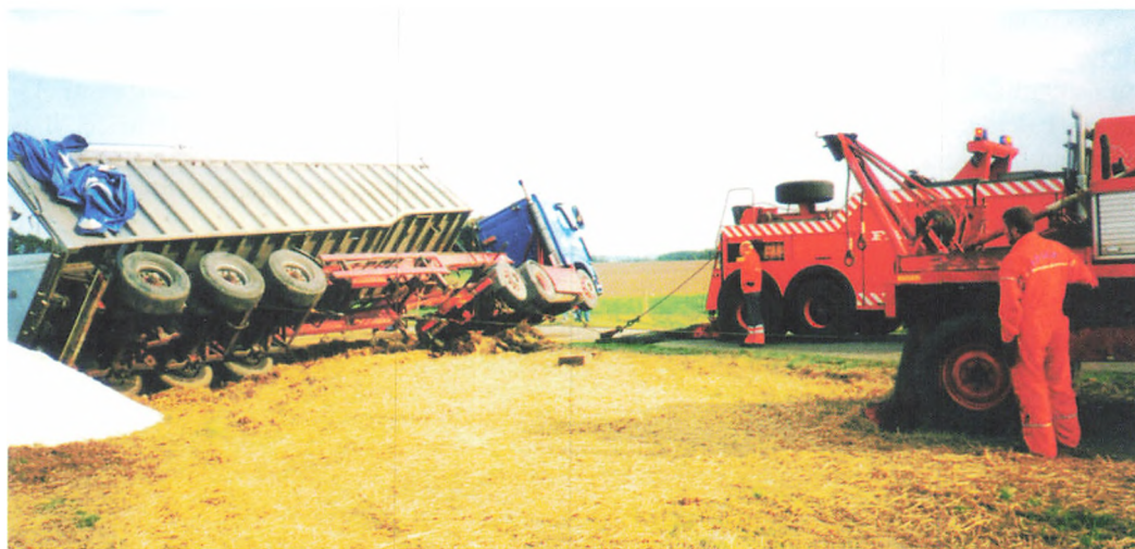
En typisk opgave for afdelingen for svær bjærgning. En væltet sættevogn kommer på højkant med hjælp fra to kranvogne. (Foto i privateje)
