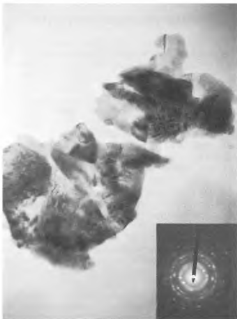
Figur 8: Et transmission elektron mikroskopbillede af nanodiamanter fra Allende meteoritten, hver klump indeholder ca. 1000 diamanter og hver diamant består af ca. 1200 kulstofatomer. Hver klump af nanodiamanter er ca. 0.0001 mm i diameter.
