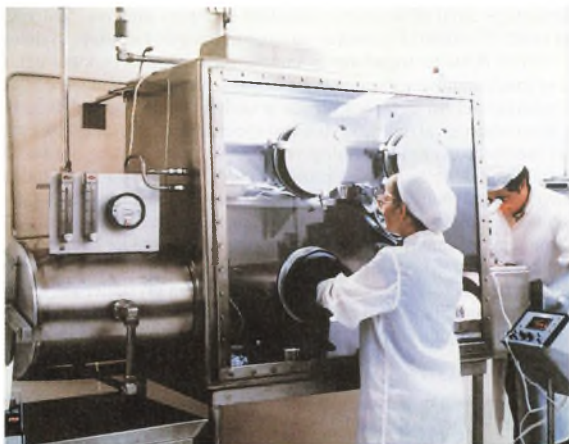
Figur 4: Laboratorieundersøgelse af en meteorit fundet i Antarktis. Meteoritten undersøges i en steril handske-kasse, hvor luften består af ren kvælstof. Kvælstofgassen er med til at holde meteoritten fri for forurening og forhindre, hvis den er jernrig, at den rustner. Teknikeren til venstre undersøger meteoritten i et mikroskop, mens at teknikeren til højre er ved at dele en meteorit, så meteorittens indre bliver synligt. (Foto: Lunar and Planetary Institute/NASA S78-32478).
