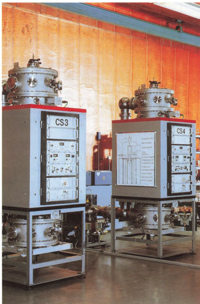
Tidssignalsenderen DCF77 styres og kontrolleres af atomure som denne CS3, der tjener som national tidsnormal for Tyskland. Nøjagtigheden i sådanne ure er formidabel. Man har opnået en afvigelse på 2 nanosekunder om dagen – en relativ nøjagtighed på 2 \times 10^{-14} eller 1 sekund på 1\frac{1}{2} million år. Foto: Physikalisch-Technische Bundesanstalt, Braunschweig und Berlin.
