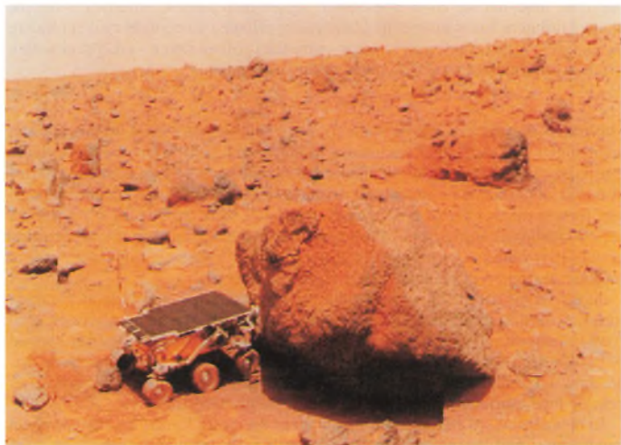
Nærbillede af Sojourner der analyserer sammensætningen af en klippeblok kaldet Yogi. Billedet er optaget af landingsfartøjet Parthfinder.
