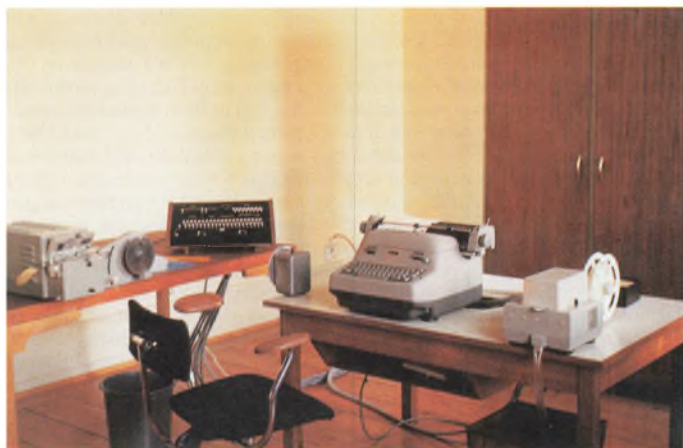
GIER elektronregnemaskinen på Østervold Observatorium. Regneenheden befinder sig i klædeskabet til højre. På bordet til venstre står strimmellæser og kontrolpanel, og på bordet til højre står skrivemaskine og strimmelhuller. Foto J. O. Petersen.
