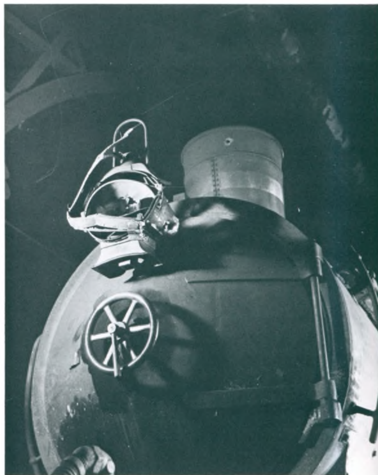
P 916 efter beskydning mellem Kværkeby og Ringsted den 25. september 1944. Ingen af lokomotivfolkene blev ramt, men maskinens sikkerhedsventil blev skudt af, og den fik adskillige andre alvorlige skader. Få minutter efter gik jagerne til angreb på endnu et tog, som blev lettere beskadiget. Både lokomotivfolk og passagerer søgte dækning, og ingen kom noget til. (Jernbanemuseet)
