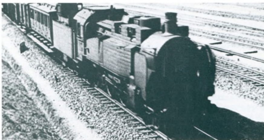
Tysk lokomotiv specielt udstyret til kørsel i Rusland. Pumper og andre udsatte ting udenpå kedlen er pakket ind i en tyk kappe af isoleringsmateriale og træ, så lokomotivet har kunnet klare den hårde russiske vinter. Det var dog sjældent, at disse maskiner kom til Danmark. (Frihedsmuseet.)
