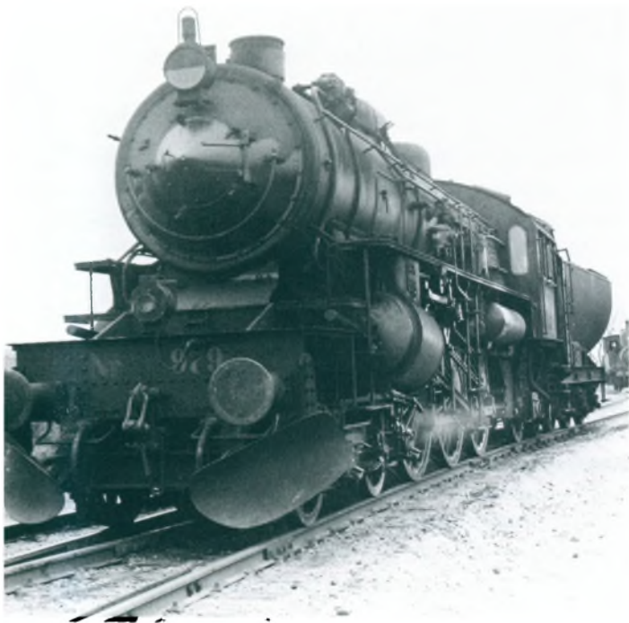
E-maskine med mørklagte lanterner. Billedet er ikke fra begyndelsen af besættelsen, hvor lanterne kun havde en lille sprække, lyset kunne slippe ud af. Den nederste lanterne er efter lokomotivmændenes krav forsynet med et »rør«, som kaster lidt lys fremad. De tyske lokomotiver havde samme slags lanterner. Det store messingnummer på kedlen er fjernet, og nummeret er malet på pufferplanken. Metal-skiltene blev brugt til reparation af lejer. (Jernbanemuseet)
