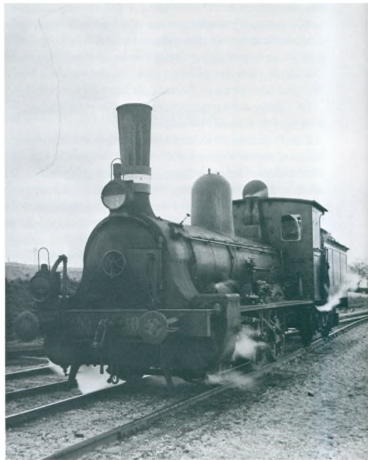
De første af de små G-maskiner var fra 1884, men det var en meget driftsikker maskine, som gjorde god fyldest på de mindre baner under hele besættelsen. Førerhuset havde ikke sidevinduer. Læg mærke til, at nummerskiltet af messing er skruet af. Nummeret er nu malet på pufferplanken, og begge frontlanterner er forsynet med mørklægningskiver. (Jernbanemuseet)
