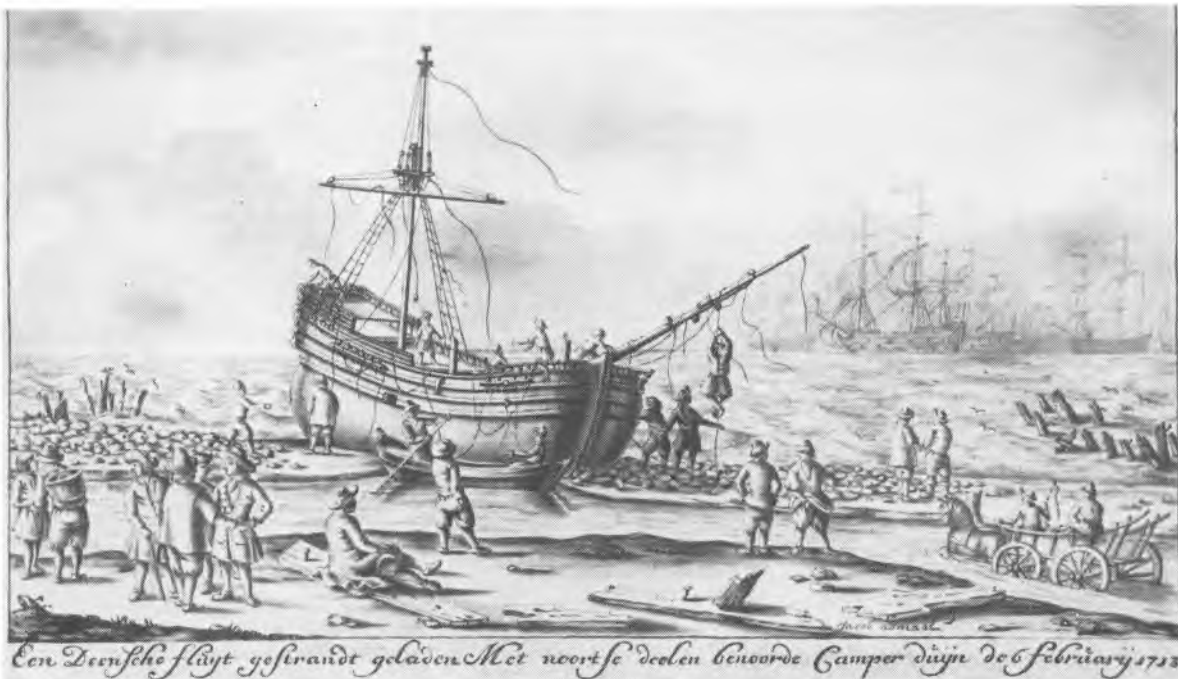
En dansk fløjt, lastet med norske planker, strandet nord for Kamperduin (i Nordholland) 6. feb. 1713. Tegning af Jacob Admiraal. Handels- og Søfartsmuseet på Kronborg. Fløjten var et bredt handelsskib, lavt i midten med en ligesom sammenkneben høj hytte agter, var med sit ringe dybgående velegnet til grunde farvande, en hollandsk type. Man er i lag med bjærgningen, også nysgærrige er kommet til.
