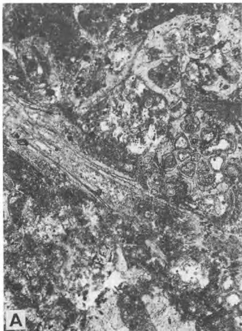
A. Tyndslib (0.015 mm tykt) af bryozokalk fra Gjerrild kirke ved Grenå fotograferet i gennemfaldende lys. Bryozokalken er opbygget af grene af bryozoaer (mosdyr) indlejret i en finkornet matrix. B. Tyndslib af kalksilsten fra Verring kirken. Af skeletfragmenter i den finkornede kalksten genkendes kun mere eller mindre cirkulære skaller af foraminiferer. Begge slib er fotograferet ved 60 ganges forstørrelse. I ældre litteratur kaldes bryozokalken ofte for limsten, medens kalksilstenen betegnes blegekridt. Også uden tekniske hjælpemidler er det let at skelne den grovkornede bryozokalk fra den finkornede kalksilsten.
