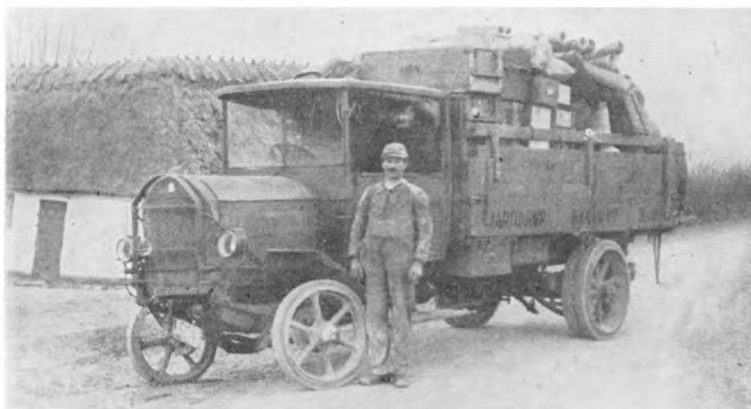
Benz Lastvogn med fast Gummi og Kædetræk. Lasteevne 5 Tons. Anvendtes 1921/22
