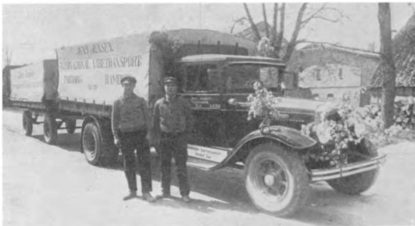
International Lastvogn med Paahængsvogn. Laster 8 Tons
