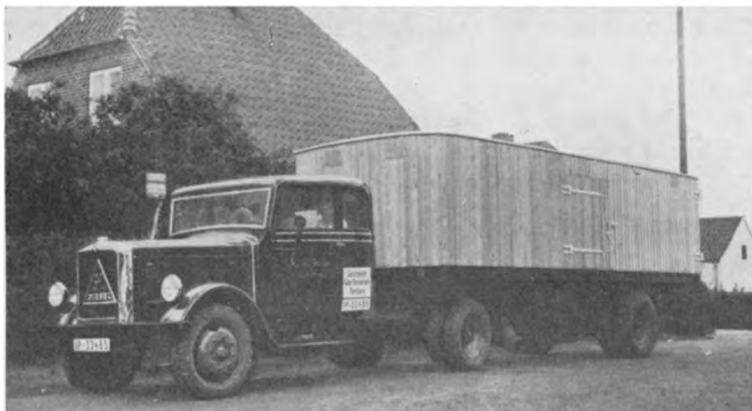
Hansa Lloyd Diezel Vogn. Model 1936. Kølevogn laster 5 Tons
