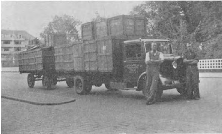
Bedford Lastvogn. Model 1925 med G. M. C. 4 hjulet Paahængsvogn
