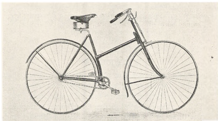
Safety, Humber med Krydsstel og massive Ringe. Fra Ingeman-Petersen: „Cyclesport“, 1891.
