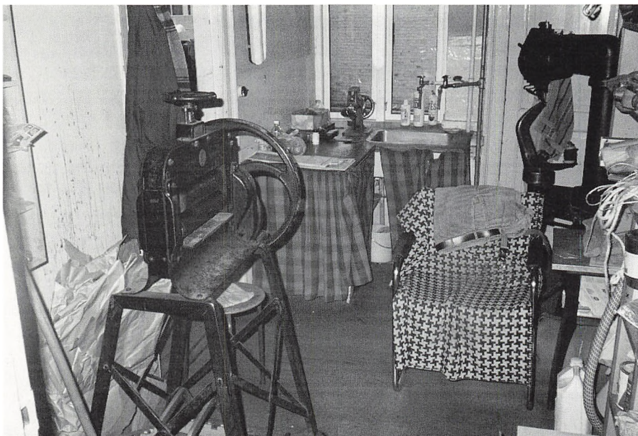
Fig. 2. Holbergsgade 12 er et byggeri fra 1888 og forretningen er størrelsesmæssigt at sammenligne med en mindre to-værelses lejlighed. Det giver ikke meget albuenum til arbejdet med maskiner, materialer o.a. Som det ses er også køkkenet inddraget til formålet. I vindueskarmen står en blokkemaskine til sko og desuden ses til venstre en lædervalse fra ca. 1941 og til højre en gennemsyner.
