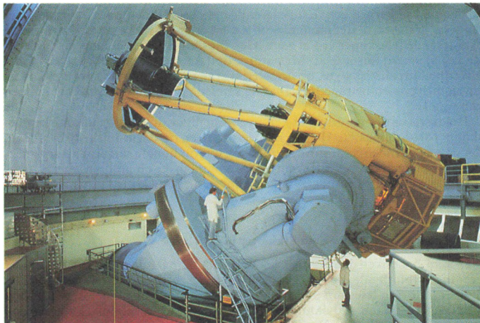
Figur 1. ESO's 3.6-m teleskop: Et stort teleskop i den klassiske tradition (Foto: ESO).
