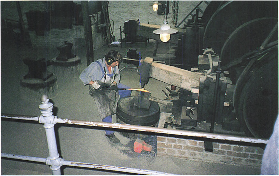
Lesmeden hamrer det glødende jern fladt med det vanddrevne hammerværk fra 1911. Westfälisches Freilichtmuseum Hagen
