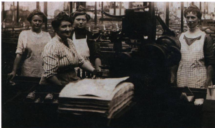
Bryggeriarbejdere. Damerne er ved at sætte etiketter på Jacobsens ølflasker. Ølkarserne var af træ og indeholdt 50 flasker øl, der skulle gode armbøffer til at løfte dem. Mellem hvert lag øl blev der lagt et ark papir fra stablen i forgrunden.
