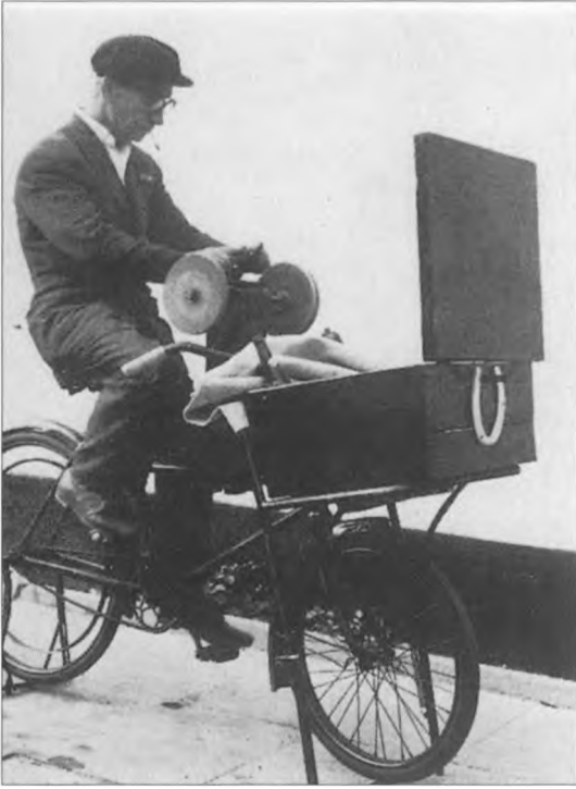
Skærslipper med sin cykel med slibesten på. Foto fra Anders Enevigs bog Prinser og vagabonder . Bragt med tilladelse fra forlaget Dansk Historisk Håndbogsforlag ved Tordenskjold Forlag 1985.
