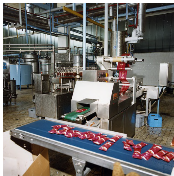
Her ses en én-banet pakkemaskine, tilkoblet en RIA 5, hvor de færdigpakkede is kommer ud i vilkårlig rækkefølge
