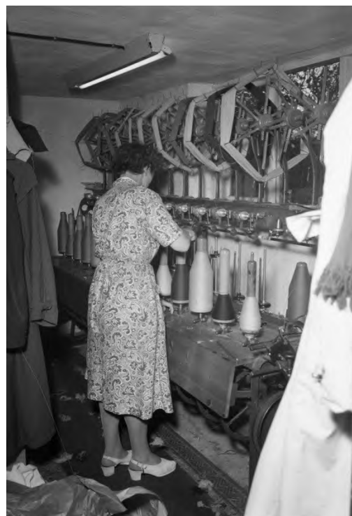
Produktionen på Tage Mikkelsens Trikotagefabrik holdt til i kælderetagen og på 1. salen. På stueetagen boede fabrikant Mikkelsen med sin hustru og søn. Her er det et kig ind i spoleriet. Hvor garn spoles på spoler, så det er klart til at blive strikket. Foto fra 1953. Foto: Hugo E/Herning Lokalhistorisk Arkiv.
