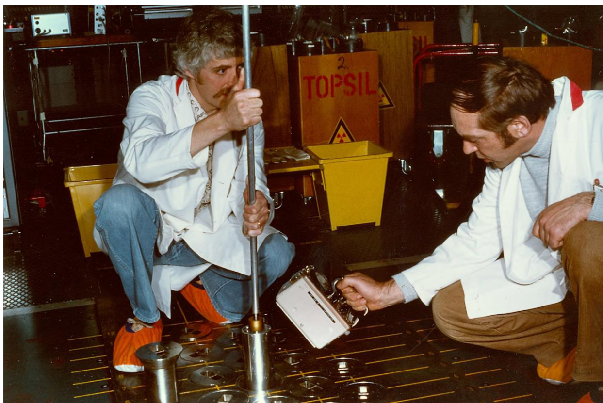
Udtagning af siliciumkrystal fra lagerområder på toppen af DR 3 følges af helseassistent med strålingsmonitor. Siliciumkrystallen er indkapslet i en dåse af aluminium og har stået til "afkøling" efter bestråling i reaktoren. Foto fra sidst i 1970'erne. Risøs Billedarkiv.
