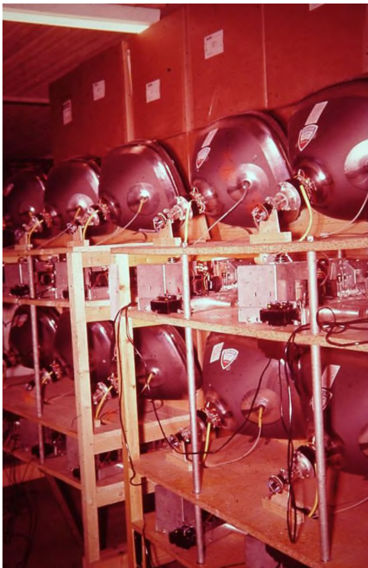
Som et led i den grundige kvalitetskontrol indgik alle billedrør i en grundig praktisk afprøvning inden monteringen. Her prøvestanden for afprøvningen. Privatfoto.
