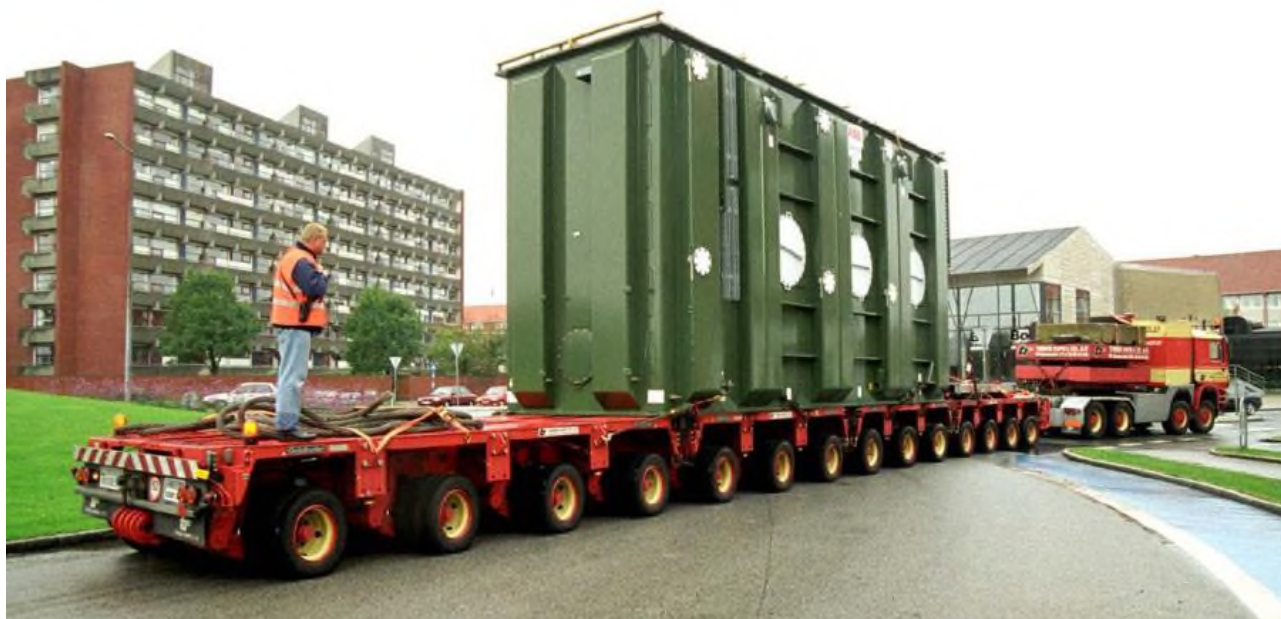
Vognmandsfirmaer har specialiseret sig i nicheområder. Her er det en blokvogn fra firmaet Torben Rafn i færd med at transportere en 280 tons tung transformator. Foto: Firma Torben Rafn.
