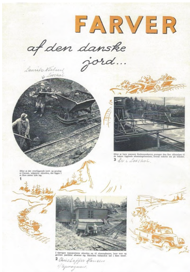
Pjecen "Farver af den danske jord" blev udgivet ved farvefabrikken Hygæas 75-års jubilæum i 1957. Den illustrerer, hvordan okkeren graves op og forarbejdes. Fig. 1-4 viser den del, Okkerværket i Løvskal tog sig af, Fig. 5-7 foregik på farvefabrikken.
