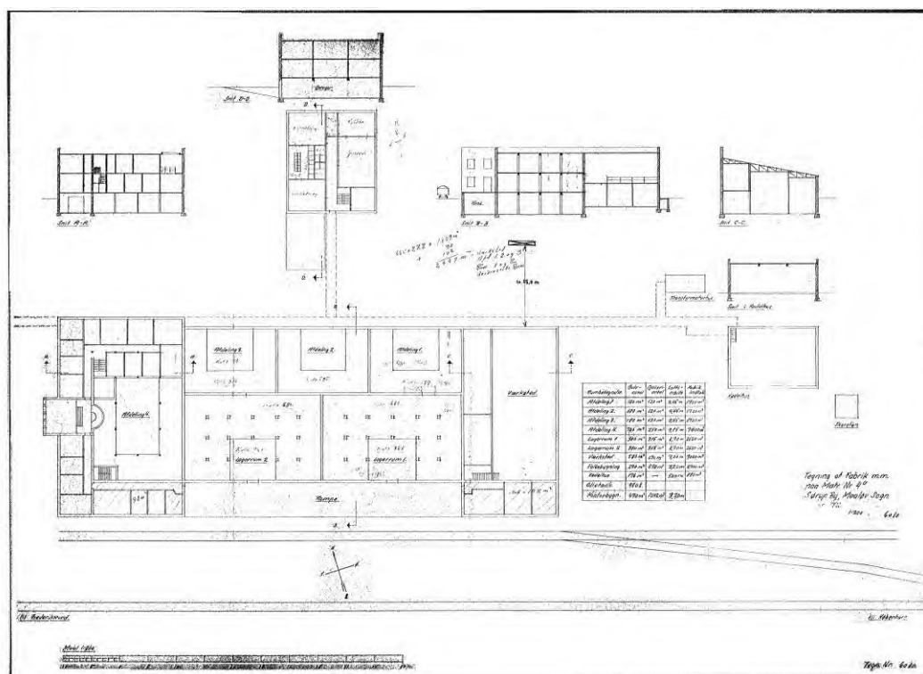
Tegningen viser et snit gennem hovedbygningen til venstre med kontorer og laboratorier, fabrikation i galleri i mellebygningen og maskinværkstedet til højre (Ballerup kommunes byggesagsarkiv).
