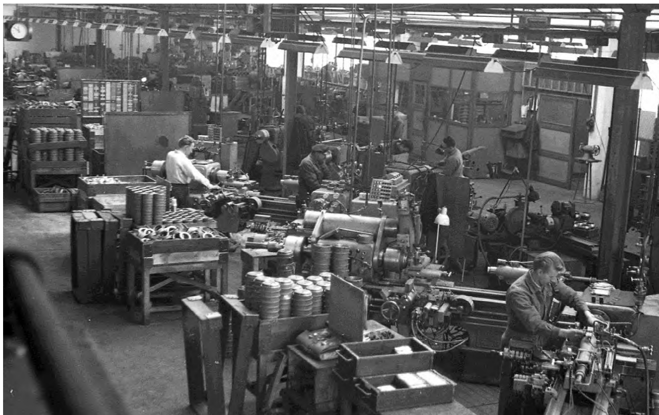
Drejeafdelingen på Bjerringbro Pumpefabrik i 1962. De automatiserede drejebænke er opstillet vinkelret på hinanden, så én operatør kunne betjene to drejebænke ad gangen. Mens den ene drejebænk udførte sit program, kunne operatøren klargøre og opspænde emnet i den næste. (Foto: Grundfos Historiske Arkiv)
