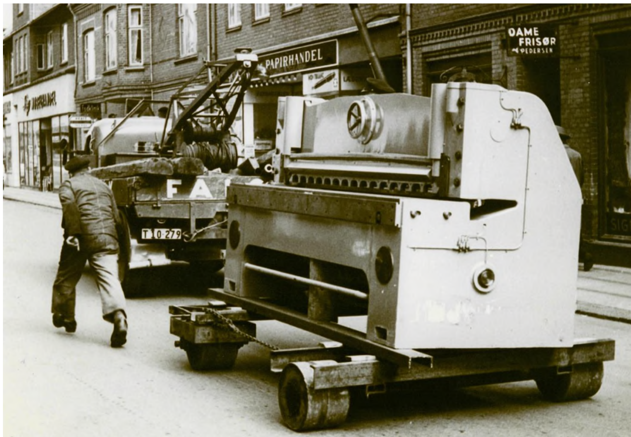
I 1950'erne blev flere og flere processer på Bjerringbro Pumpefabrik mekaniseret. De håndværksprægede værksteder transformerede sig til maskinhaller. Her køres en ny pladesaks gennem hovedgaden i Bjerringbro i 1956. [Foto: Grundfos Historiske Arkiv]
