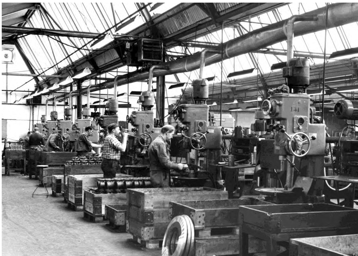
Boreafdelingen på Bjerringbro Pumpefabrik i 1964. Det var ikke alle processer, der kunne betale sig at automatisere. Hvis der var tale om små styktaal eller processer med få operationer, som i boreafdelingen, kunne det ikke svare sig. Mens størstedelen af fabrikkens drejeafdeling arbejdede med automatiserede maskiner i 1964, forblev boreafdelingens maskiner manuelt betjente. (Foto: Grundfos Historiske Arkiv)
