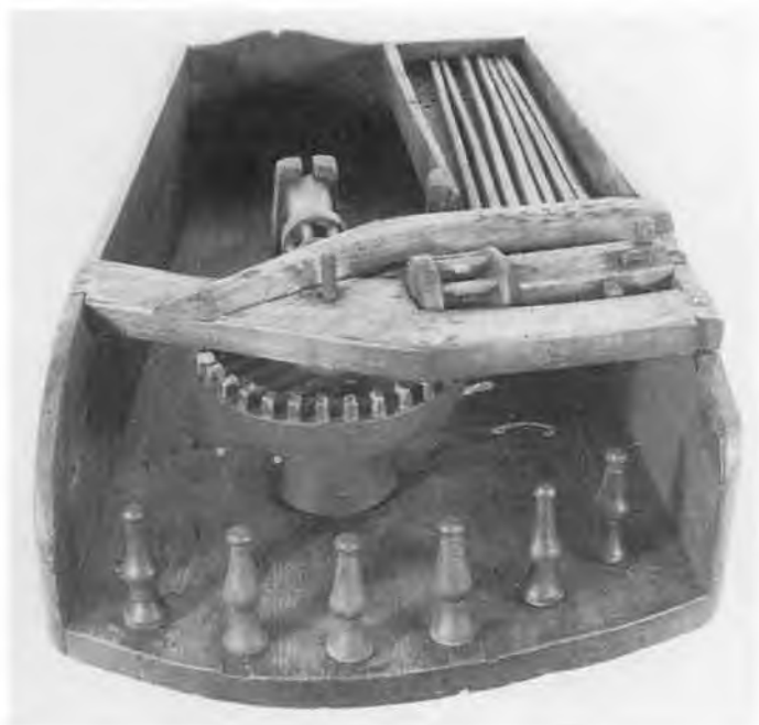
Model af tærskværk efter plejlprincippet muligvis efter skotten Michael Menzies, ca. 1740. Dansk Landbrugsmuseum nr. 4487.
