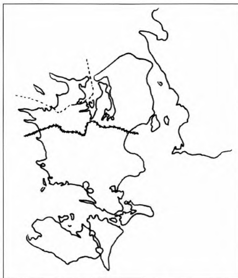
Fig. 6. Sidebåndskonstruktioner i nyere tid. Den stiplede linje viser udbredelsesområdet for det indvendige sidebånd (nord og vest for linjen). Linjen med de små kryds viser grænsen mellem udvendigt sidebånd (nord for linjen) og løsholtbyggeri (syd for linjen). Lerche s. 195.
