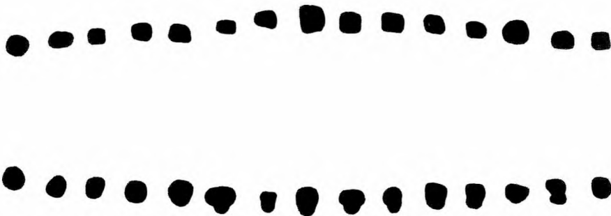
Fig. 7. Fra spærtageets første udviklingstrin. Hus LXXXIII fra Vorbasse fra slutningen af 1000-tallet. Den stramme symmetriske stolpestilling tyder på, at hvert stolpepar har været forbundet på tværs af en bjælke, der har optaget spærenes udadrettede tryk på væggene. Mål ca. 1:200. Efter Holger Schmidt, 1999, fig. 34.
