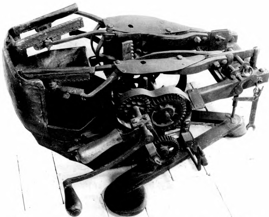
Fig. 14. Zincks malkemaskine, ca. 1890. En meget kompliceret maskine, som mekanisk efterlignede håndmalkningen. Den kom aldrig over forsøgsstadiet. Foto: Dansk Landbrugsmuseum.
