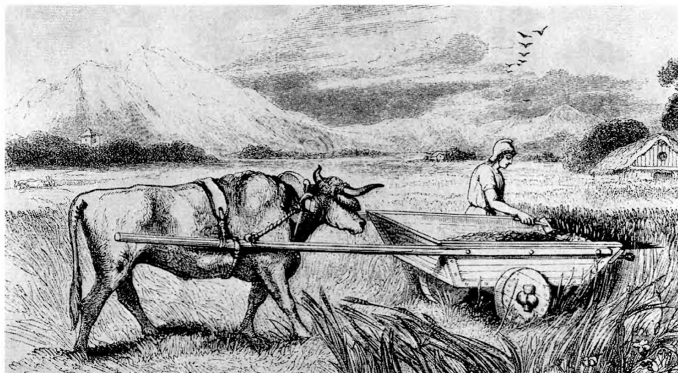
Fig. 1. Den gallo-romerske høstvogn afhøstede kun kornakset. Indtil McCormicks høstmaskine kom i 1831, blev alle høstmaskiner skubbet ind i afgrøden. Illustration fra Det danske Landbrugs Maskinbog , 1941.
