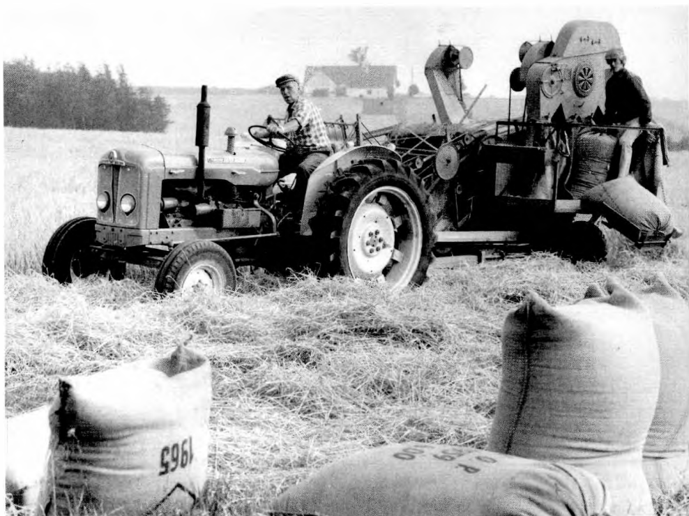
Fig. 8. Med mejetærskeren flyttede hele høstarbejdet ud i marken. En lille Dronningborg, sække maskine trækkes her af en Fordson Super Major. Der er kraftoverføring til mejetærskeren. Arbejdet kræver stadig to mand og så skal halmen opsamles og presses bag efter, hvis ikke den brændes af direkte på marken. Foto Bornholmeren 1972, Bornholms Museum.
