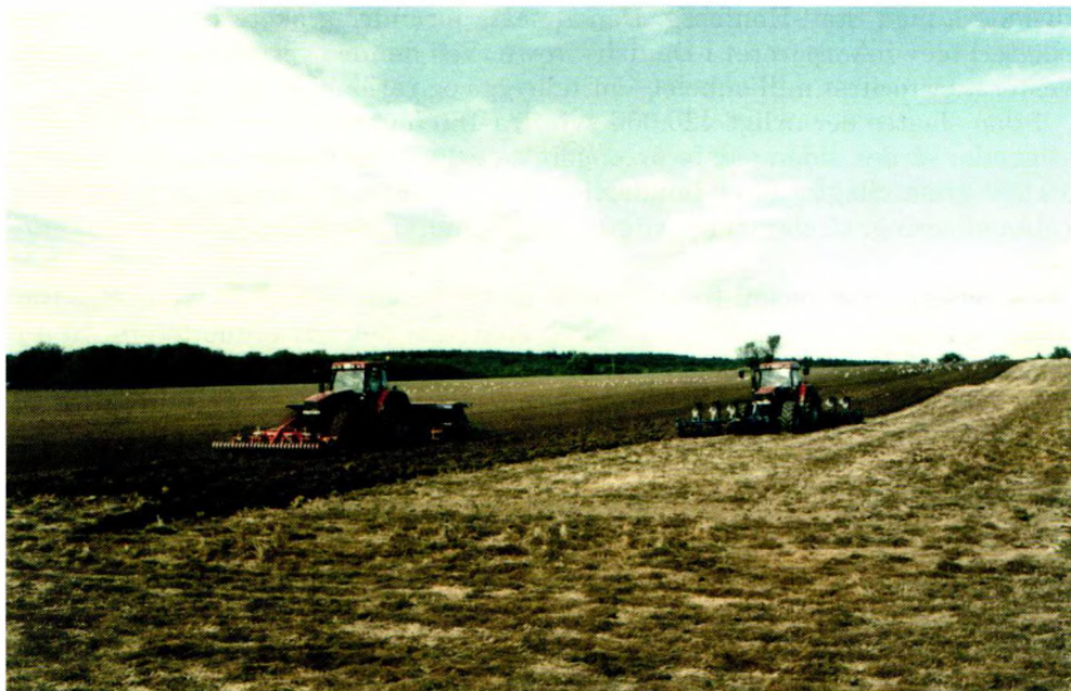
Fig. 6. I 2005 foregår pløjning og såning ofte med to traktorer lige efter hinanden. Den ene traktor er monteret med tre pløjelegemer foran og fem pløjelegemer bag på traktoren. Den anden traktor har harven monteret foran og såmaskinen samt efterharve bag på. Foto H.V. 2005, hvor Nexøvejen skæres af Grødby Å, Bornholms Museum.
