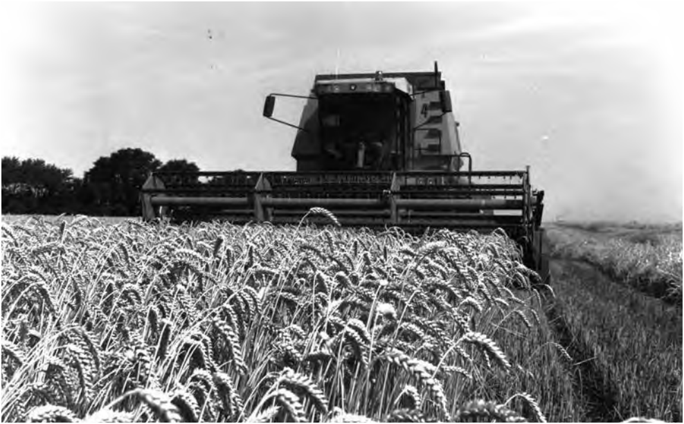
Figur 5: Mekaniseringen betød voldsom effektivisering i landbruget, ligesom det skabte en betydelig vækst i produktionen for en række industrier, der fremstillede landbrugsmaskiner. Her er det en selvkørende Dronningborg mejetærsker. Dronningborg fabrikkerne blev grundlagt i 1894 ved Dronningborg Mølle uden for Randers af N. Kristian Nielsen og videreført af hans søn, I. Damgaard Nielsen. I dag er virksomheden ejet af et amerikansk firma. (Kilde: Dansk Landbrugsmuseum, Gl. Estrup).
