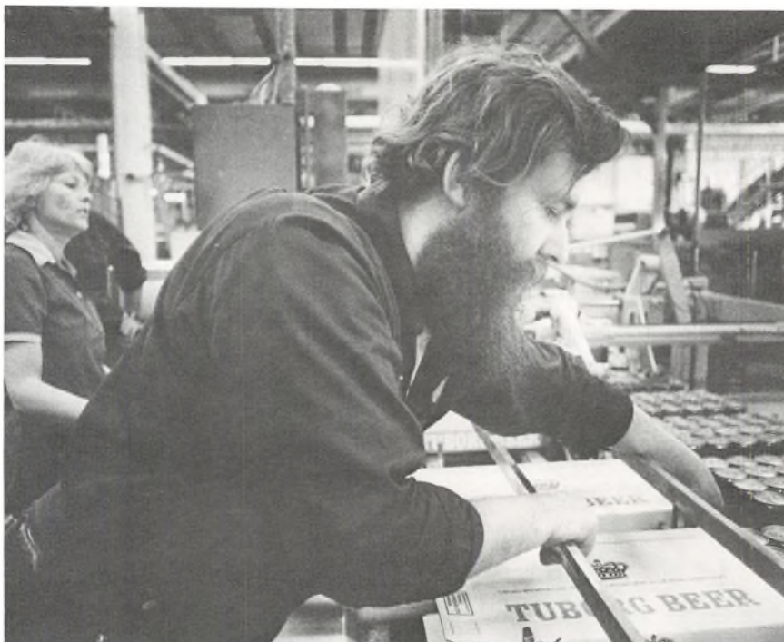
Ved pakning af helkartoner skubbes dåserne ind i æsken. Når der opstår problemer, hvad der nemt gør, skal ny karton anbringes manuelt.
