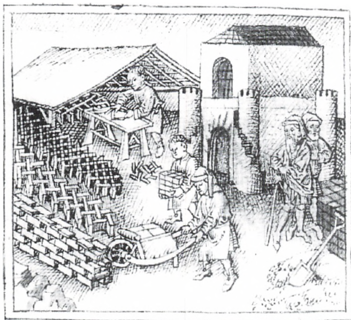
Fremstilling af teglsten. I baggrunden slås leret i form, i forgrunden stables stenene til tørring, før de brændes. Illustration til Utrecht-biblen, omkring 1400.
