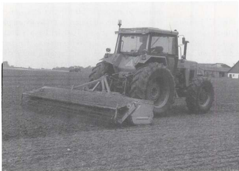
Traktoren er en Massey Ferguson 2725 årgang 85, 150 hk og firehjulstrukken. Den er forspændt en 4 m bred roterende harve med 240 tænder. Med kun en operation kan en afbrændt hvedemark som her tilberedes som såbed.
