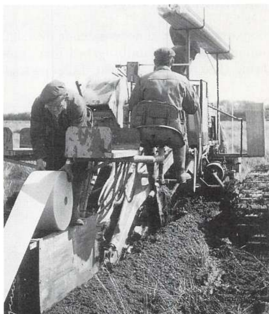
En moderne drænlægningsmaskine til plastrør; samtidig tildækkes rørene med glasuldsfiber.
