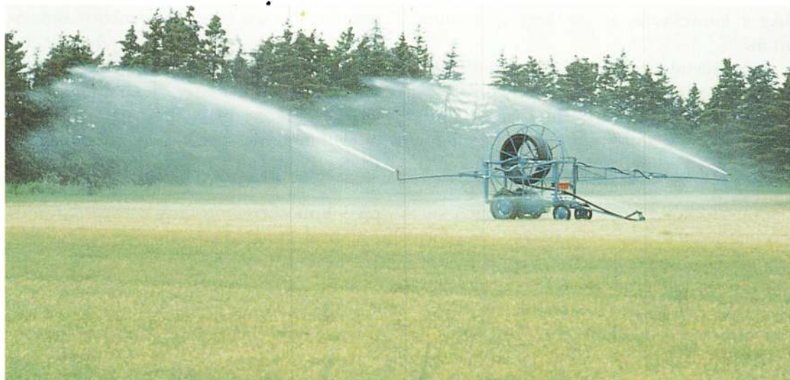
Dansk vandingsmaskine, opbygget over en skrottet traktor. Systemet drives ved vand fra en almindelig boring. Et alternativt system er sprinkleranlægget, som især anvendes ved gartnerier.
