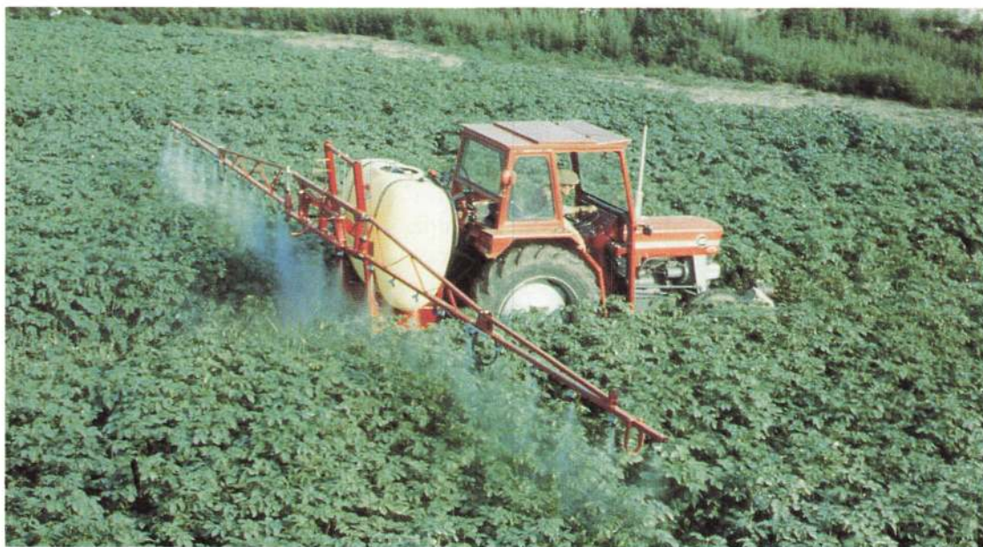
Kartoflerne sprøjtes mod kartoffelskimmel. Behandlingen foretages i forebyggende øjemed hver 14. dag fra slutningen af juni. Sprøjteaggregatet kan også anvendes i kornmarken.
