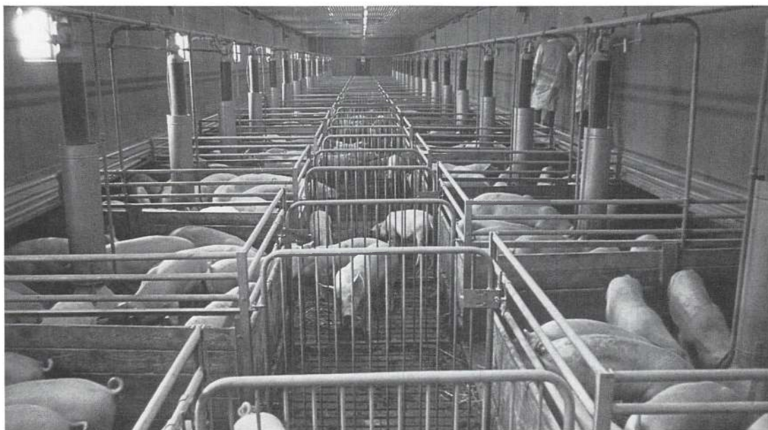
En moderne slagtesvinestald med automatisk fodringsanlæg og tremmegulv.
