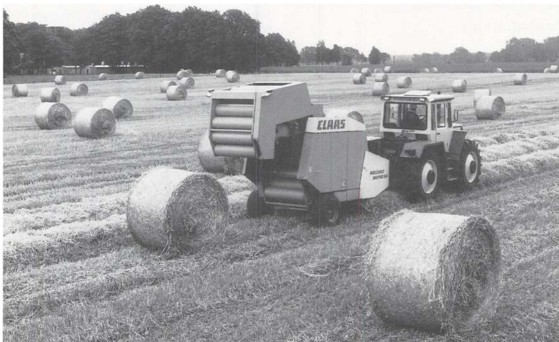
Halmen fra mejetærskningen presses til rundballe. Denne rundballepresse udfører arbejdet i en kontinuert proces uden behov for at standse op.
