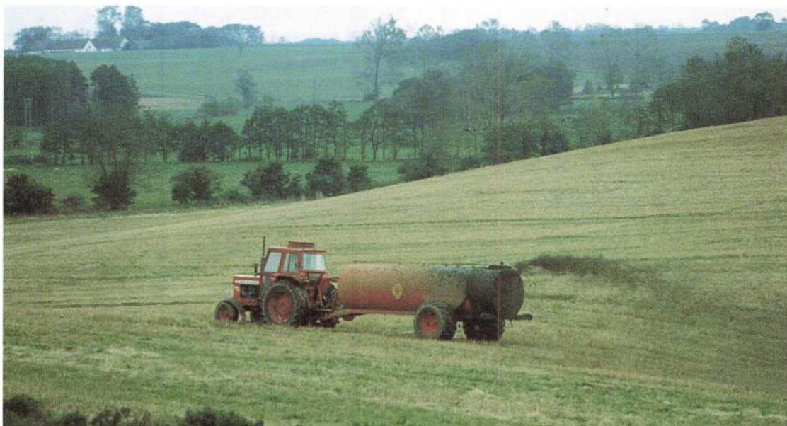
Gyllevognens indhold spredes i et bælte på ca. 8 m. Trækraften leverer traktoren via kardanakslen.
