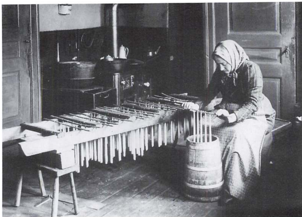
På dette moderne fotografi af lysstøbningsprocessen ses, hvad Ingeborg mente med udtrykket, »han trivedes, ligesom når der støbes lys«. Fåretælgen i tønden sætter sig lag på lag omkring vægen, der stikkes ned i tønden. (Foto fra Nationalmuseet, negativ nr. 55.400).
