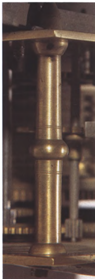
Fig. 33: Værkpille med vulst til et empireurværk, lavet af Jørgen Møller (fig. 17). Den gamle By i Århus.
