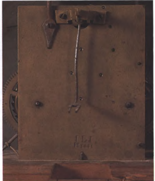
Fig. 28: Bagpladen til et barokurværk, Claus Jørgensen Bohns ur no. 234, den er individuelt udformet med smukke detaljer. Den gamle By i Århus.
