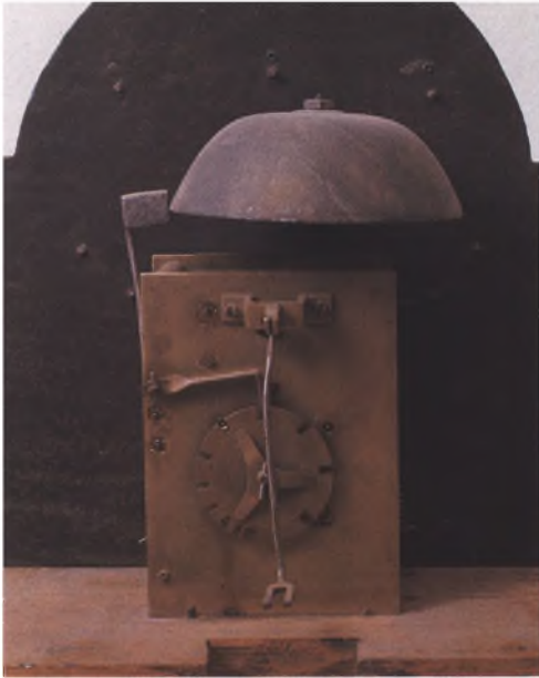
Fig. 27: Bagpladen til uret i fig. 1, visende slagskiven.
