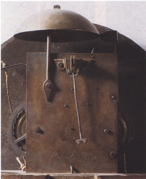
Fig. 27: Bagpladen til uret i fig. 1, visende slagskiven.
