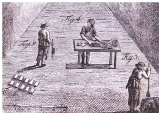
Tegning fra J. A. Dyssels vejledning til bønderne fra 1772: Til højre tilberedes leret, i midten står strygeren og til venstre hjælperen, der bærer sten til tørring på jorden.
