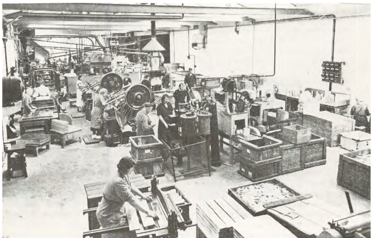
Overgangen fra transmissionsdrift med en central kraftkilde til enkeltrevne maskiner med hver sin elektromotor kunne ændre et fabriksinterieur radikalt. Her Hastrup før og efter. (Kilde: H. H. Seedorff Pedersen og Martin N. Hansen, Aktierselskabet Hastrup, 1939, side 36).
