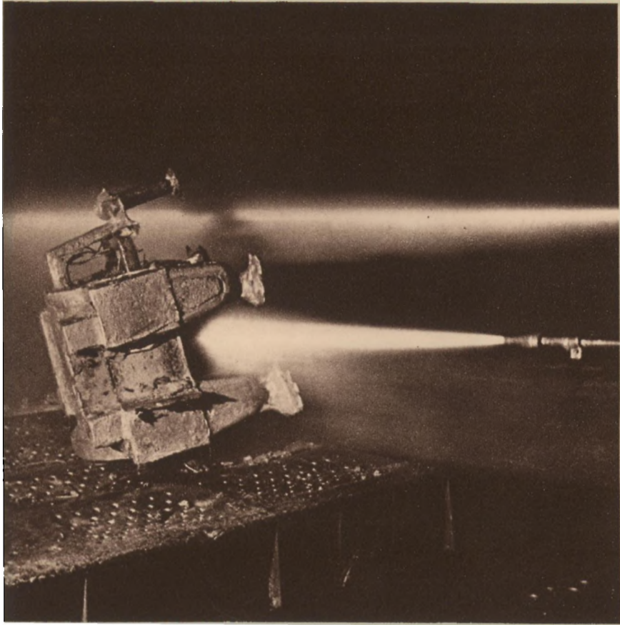
In einem Uraler Werk für Schwermaschinenbau. In besonderen, gut isolierten Wasserkammern werden die Gußstücke vom Formsand gesäubert. Eine solche Säuberungsmethode ist bedeutend leichter als Handarbeit und macht die Arbeitsräume der Gießereien staubfrei.
