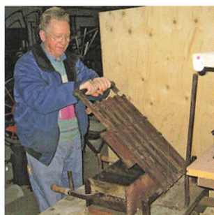
Cementblanding kommes i formen, jernrammen slås hårdt ned, stenene løftes ud og lægges til tørre. Johs. Elbæk viser processen på Landbomuseet.
