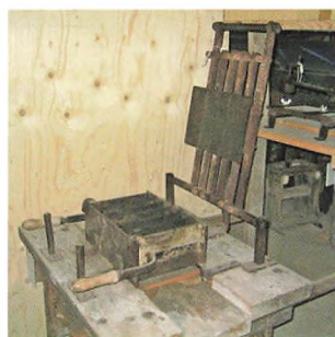
Cementblanding kommes i formen, jernrammen slås hårdt ned, stenene løftes ud og lægges til tørre. Johs. Elbæk viser processen på Landbomuseet.
