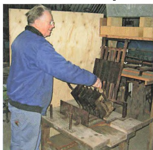
Cementblanding kommes i formen, jernrammen slås hårdt ned, stenene løftes ud og lægges til tørre. Johs. Elbæk viser processen på Landbomuseet.
