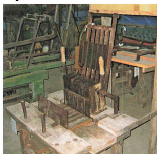
Cementblanding kommes i formen, jernrammen slås hårdt ned, stenene løftes ud og lægges til tørre. Johs. Elbæk viser processen på Landbomuseet.
