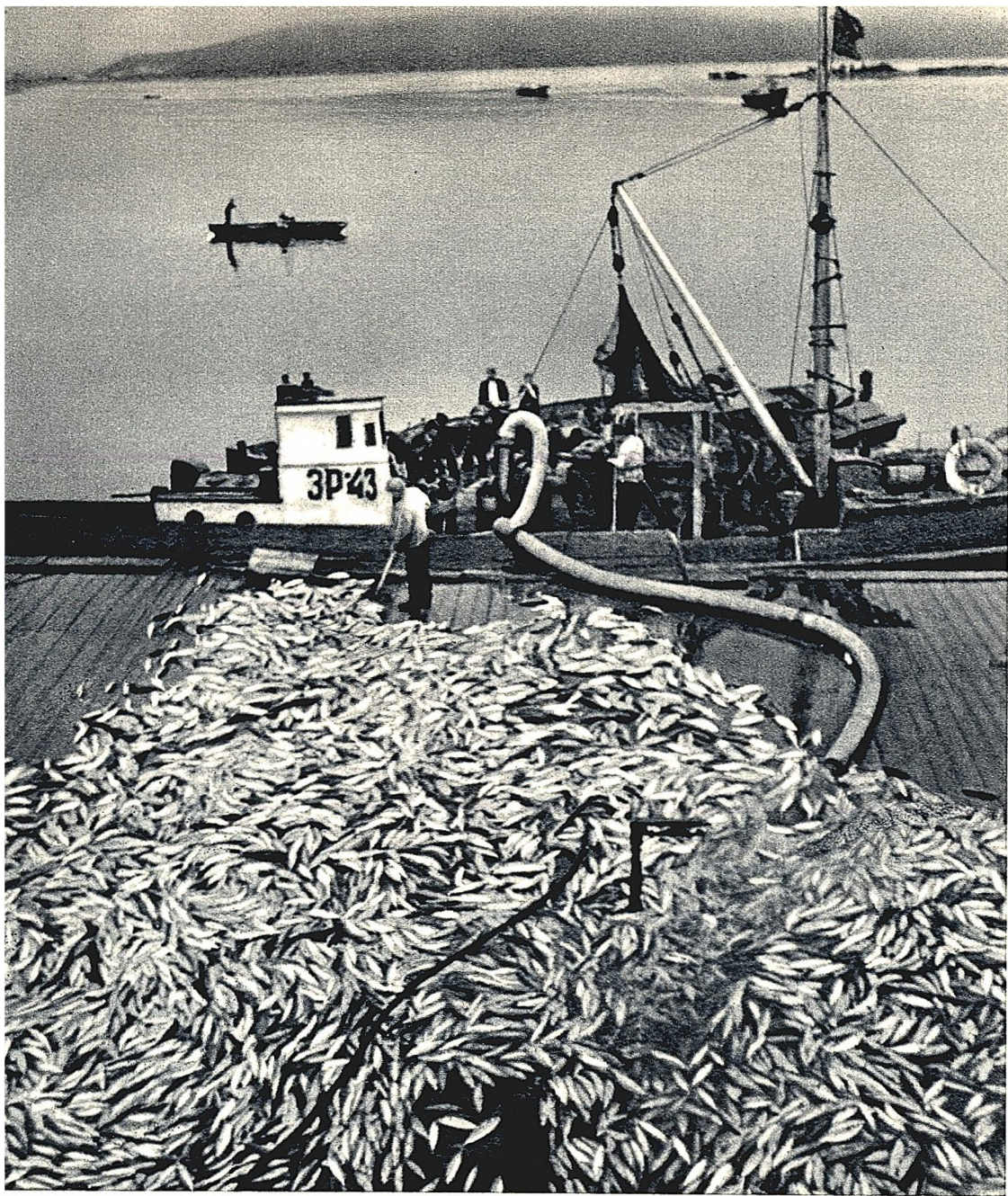
in breiter Schlauch wird in den vollen Laderaum hinabgelassen und durch ihn der Fang heraufgepumpt. Diese von dem Sowjetingenieur Tschernigin konstruierte Fischpumpe löscht Fischereischiffe. Sie leistet die zeit- und kraftraubendsten Arbeiten und ersetzt Hunderte von Lastträgern
