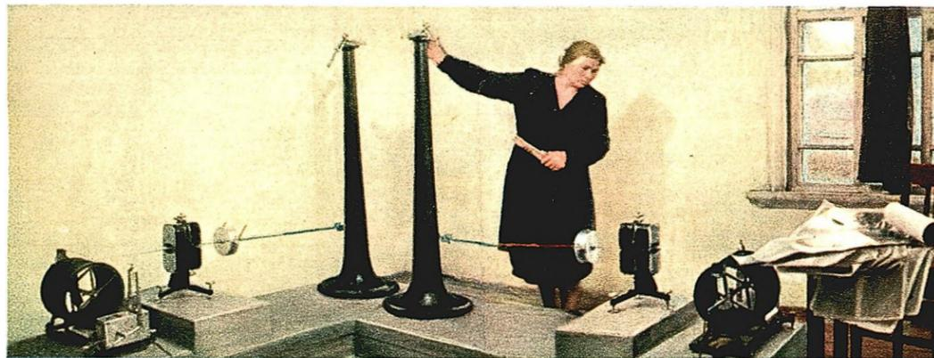
Die geringsten, durch eine Vulkaneruption oder ein Erdbeben hervorgerufenen Bodenschwankungen werden von den Seismographen der vulkanologischen Station aufgezeichnet. Die Seismologin W. P. Enman liest regelmäßig die Angaben der hochempfindlichen Apparate ab
