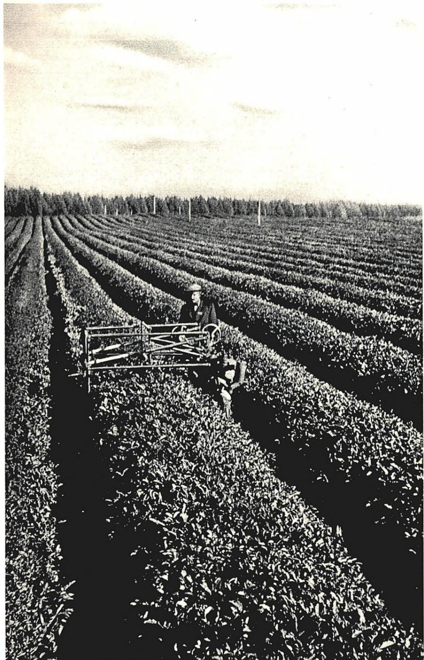
**DIE MASCHINE AUF DEN TEEPFLANZUNGEN.** Der sowjetische Konstrukteur und Agronom P. Kostawa hat eine Maschine erfunden, die die Mechanisierung einer Reihe von mühevollen Arbeitsgängen beim Teeanbau erlaubt: den Zuschnitt der Stauden, die Düngung in bestimmten Dosen, die Kultivierung, die Lockerung des Bodens u. a. Unser Bild: Der von Kostawa erfundene, mit selbständigem Antrieb ausgestattete Teekultivator bei der Arbeit Photo B. BURAWLOW
