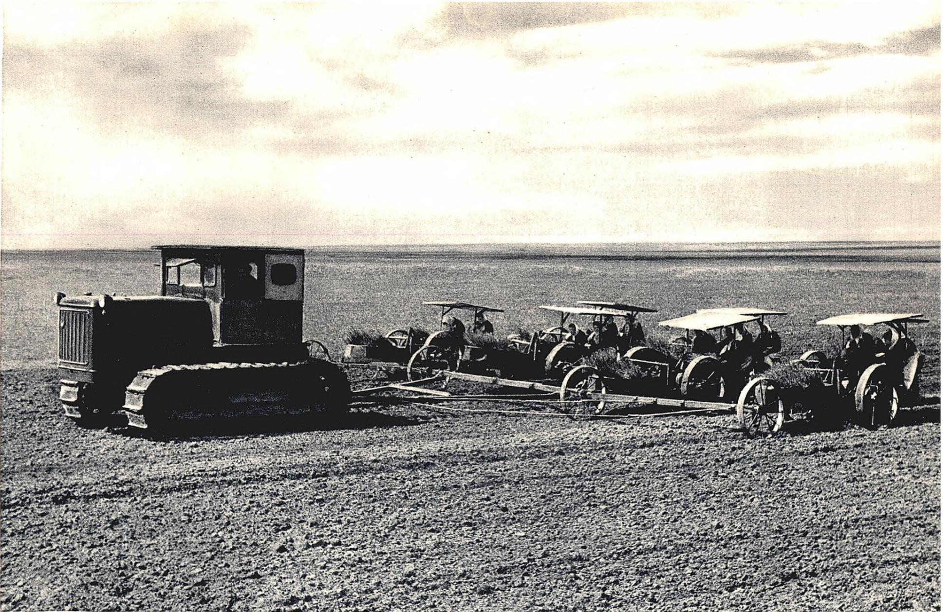
Im Bereich des staatlichen Forstgürtels Belgorod–Asowsches Meer (Schutzforststation Tschugujew) wurde die Auspflanzung der Setzlinge vorfristig abgeschlossen. Unser Bild: Ein Schlepp von sieben Aufforstungsmaschinen, Marke „SLN-1“ (Konstruktion des sowjetischen Ingenieurs A. Nedaschkowski) bei der Auspflanzung von Setzlingen
