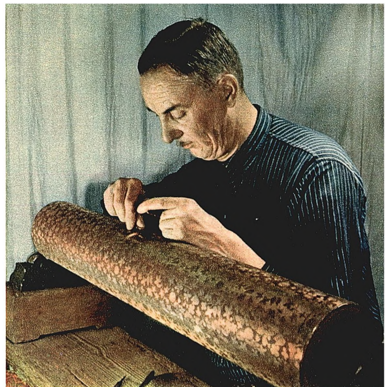
Nikolai Alexandrow, einer der erfahrensten Graveure des Kombinats, überträgt ein neues Muster auf die Walze
