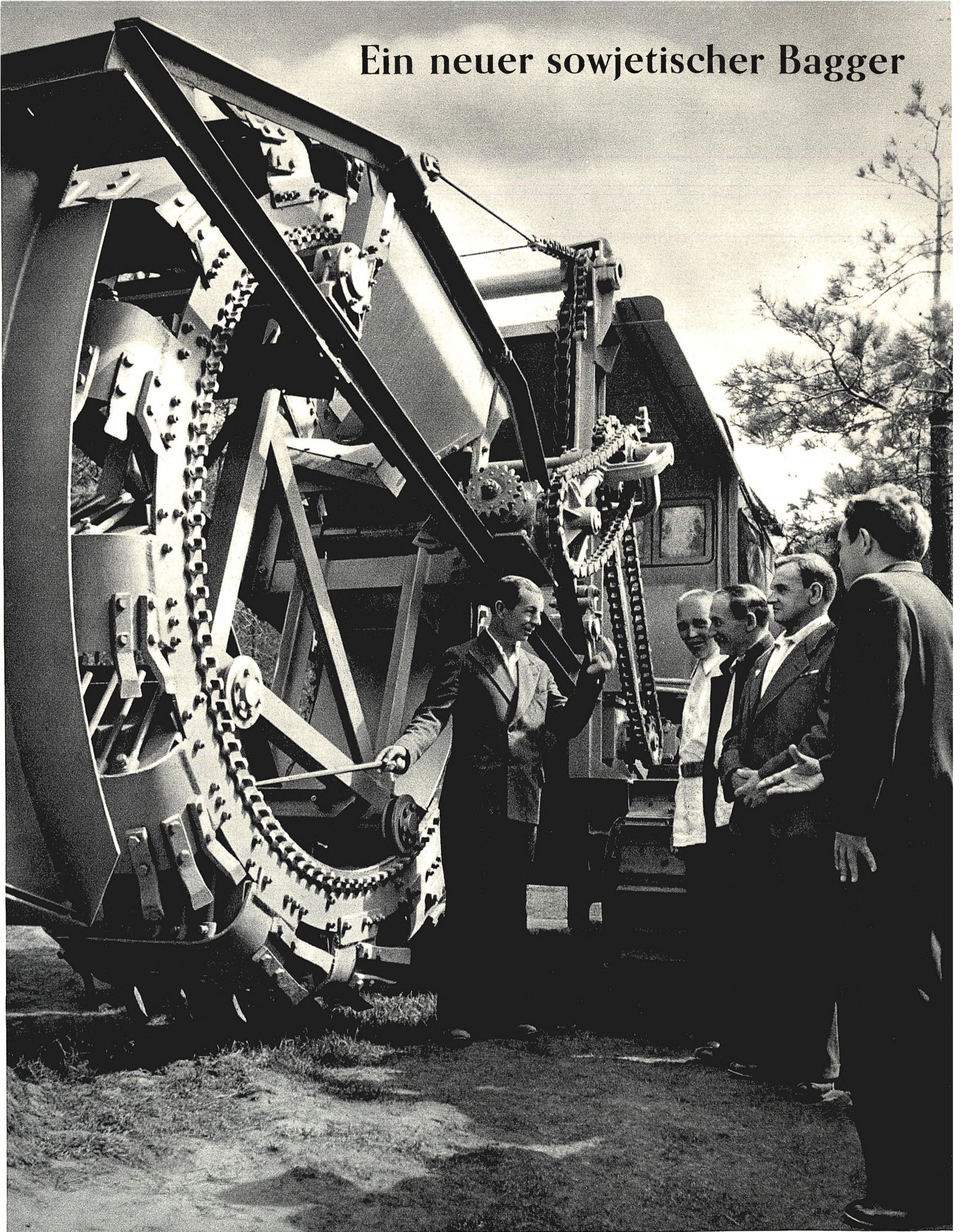
Auf der Bauausstellung im Sokolniki-Kulturpark (Moskau) ist ein neuer rotierender Bagger ausgestellt, der 300 Kubikmeter Erddreich in der Stunde aushebt
