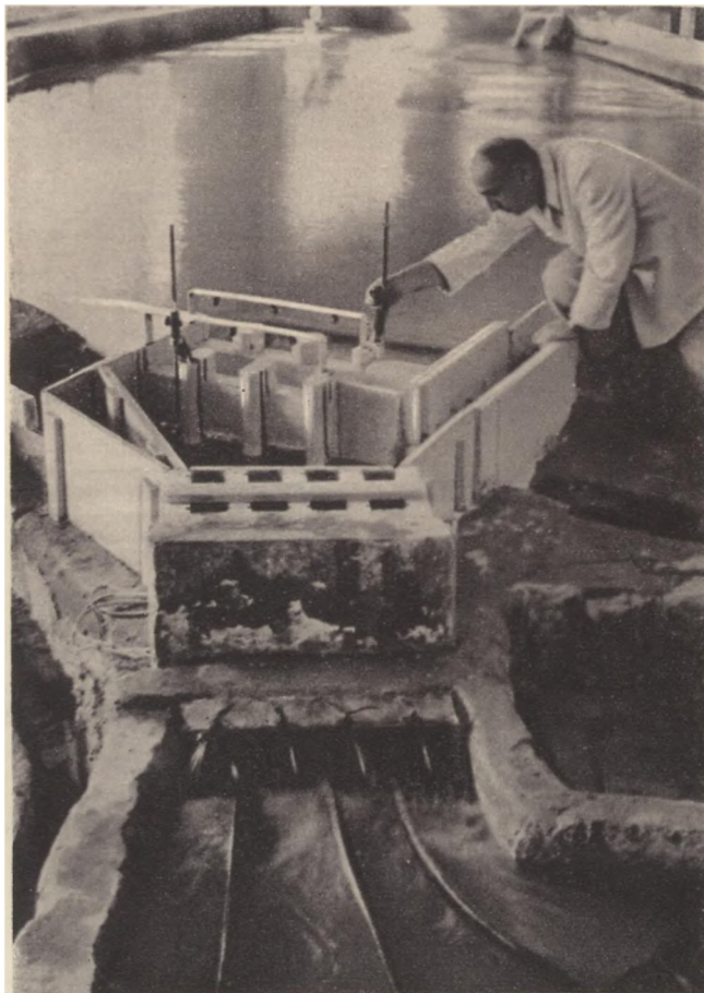
A. Ananjan, Leiter des hydroelektrischen Laboratoriums beim Institut für Wasserenergie, untersucht den Wellengang am Modell des Beckens zur Regulierung des Tages-Wasserhaushalts
