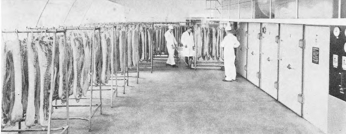
En typisk baconafdeling i en D.B.C.-engrosfilial, der viser den moderne røgeovn med rene, polerede vægge af en aluminiumslegering, og hvor der er fuldstændig kontrol med temperatur, fugtighedsgrad og røgmængde.
