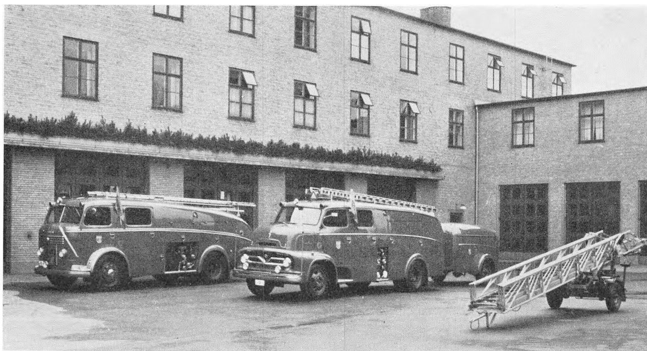
Et moderne slukningstog omfatter de foran nævnte 2 sprøjter samt ved brand i høje huse en drejestigevogn og den viste påhængsstige på 19 meter.
