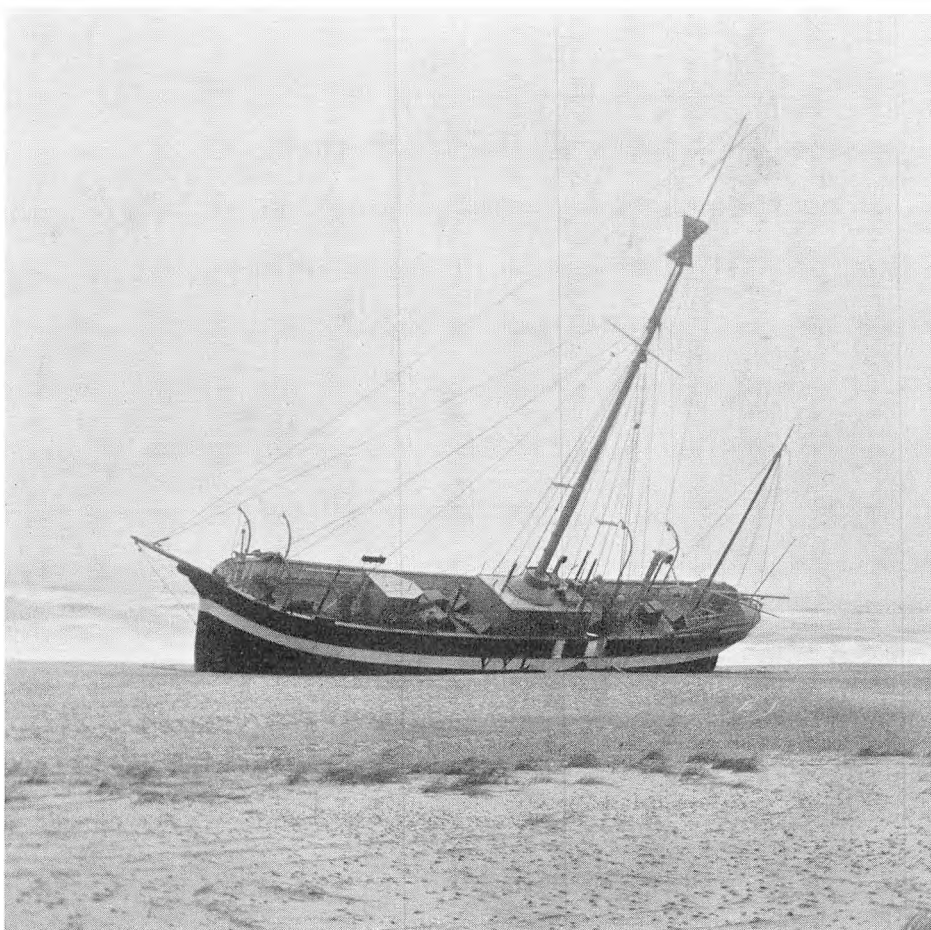
Vyl fyrskib på tørt land ved Bjerregård strand efter sprængning af ankerkæden på sin station SW. for Horns Rev. I modsætning til andre danske fyrskibe, der havde en rød ballon, førte Vyl en timeglasformet figur på mastetoppen.
