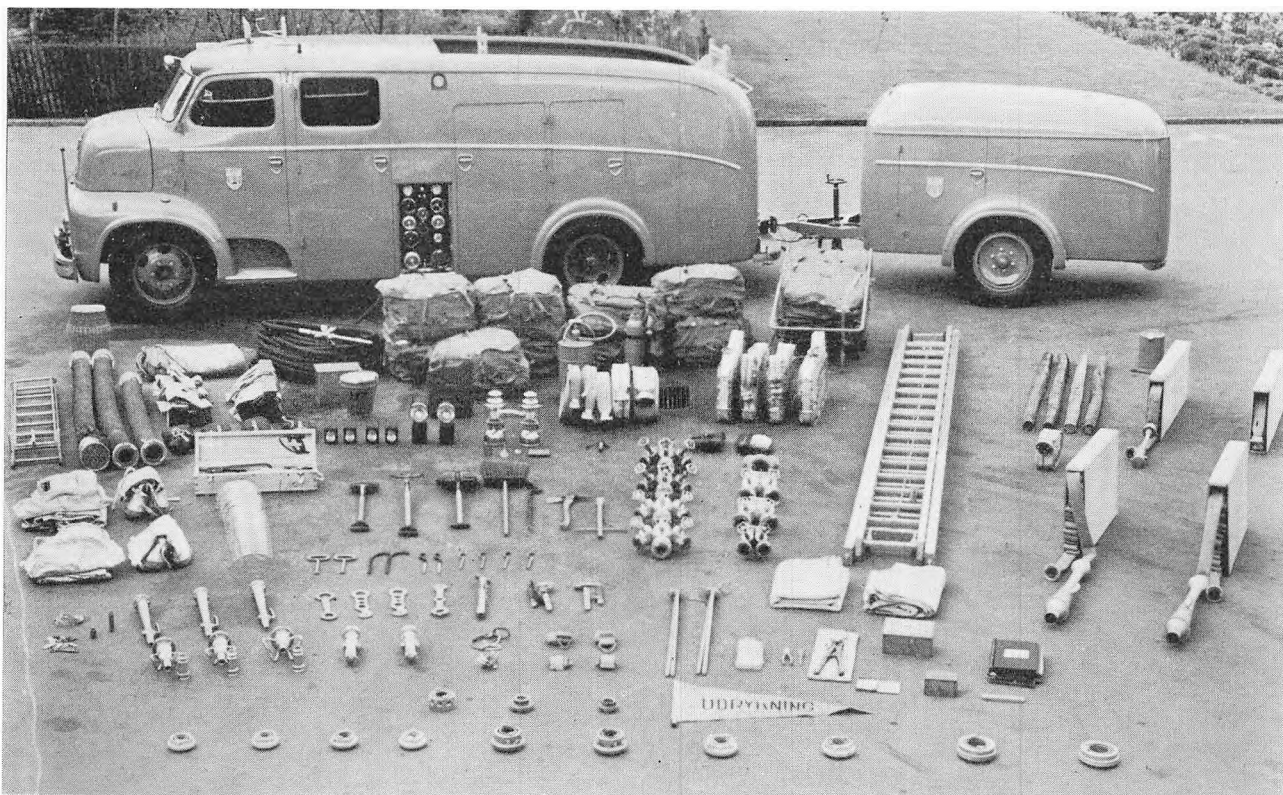
Motorsproje med påhængs-skumvogn fra 1955 og en slangemængde på 1150 meter. Skumvognens ene skumanlæg får i første omgang vand fra motorvognen og kan dermed producere 5000 liter skum pr. minut i 15 minutter. Med det andet skumanlæg produceres 4000 liter stift skum i løbet af 4 minutter.
