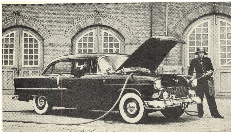
Inspektionsvogn med vandtank, pumpe m. v. fra 1956.
