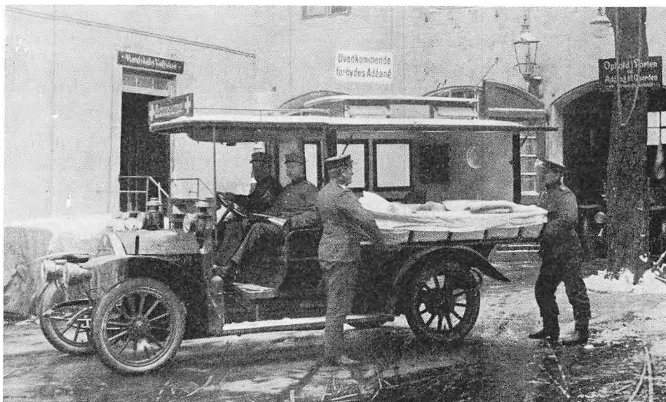
Ambulance- og sygevoan fra 1910. Bårcindføringen fra siden blev dengang anset for ideel. Den blev dog hurtigt opgivet igen og er ikke forsøgt siden.
