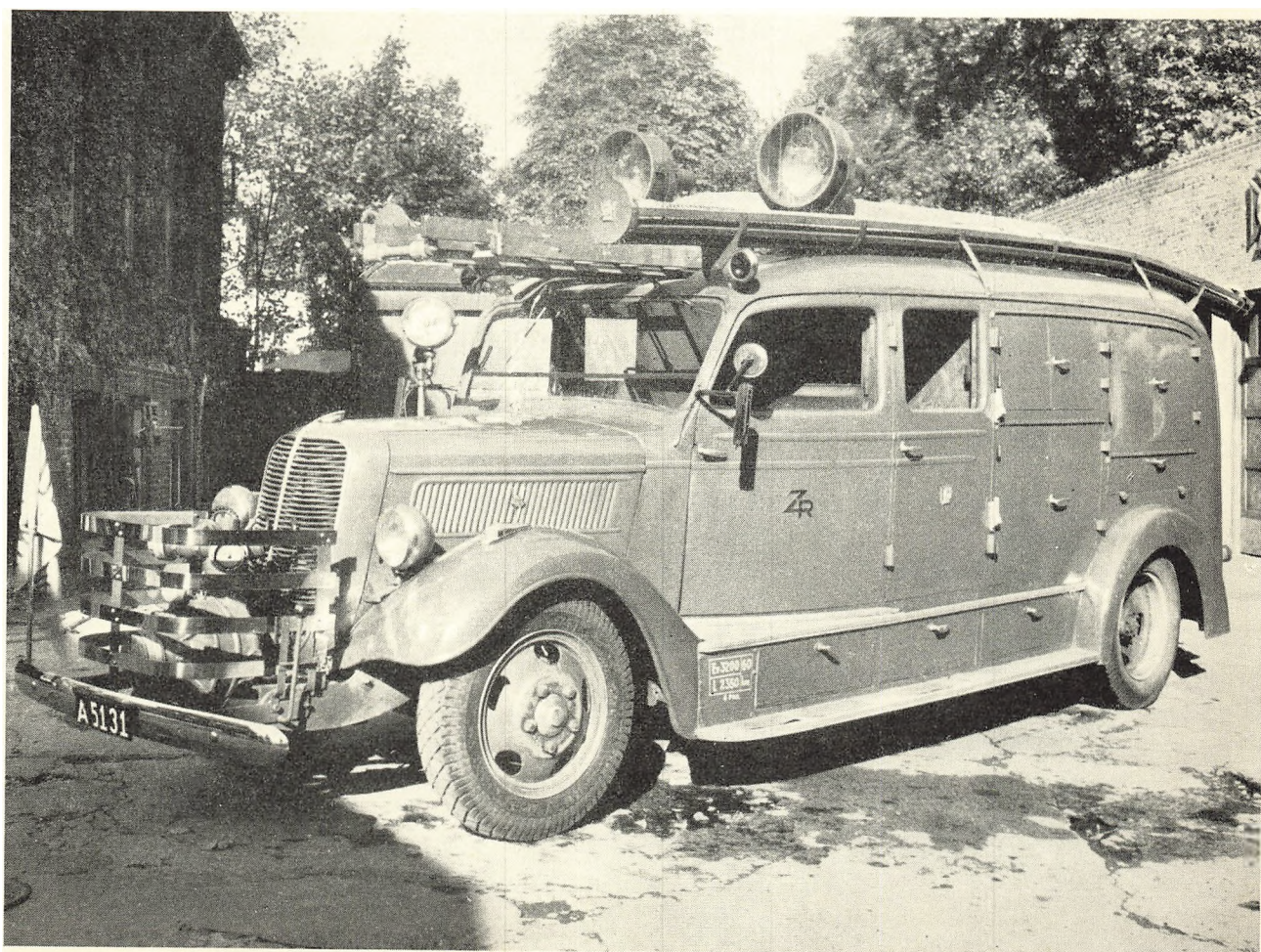
Zonens katastrofevogn -- den rullende redningsstation. Den er udstyret med alt nødvendigt redningsmateriel, herunder f. eks. særligt katastrofeværktøj, røgudsugere, gummibåd, asbest- og gasdragter m. m.
