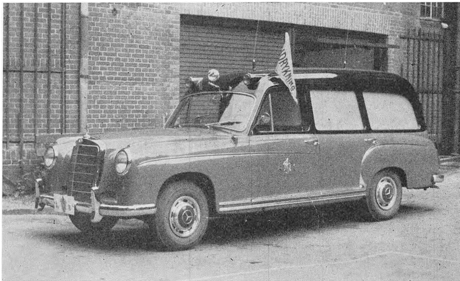
Ambulancevogn model 1958 fra Københavns brandvæsen. Bårerummet har dobbeltdør bagtil og en dør i højre side. Båren er anbragt i rummets venstre side og i højre findes et klapsæde samt en lænestol, der kan sænkes til vandret stilling, hvorved der skabes mulighed for at medføre endnu en patient.
