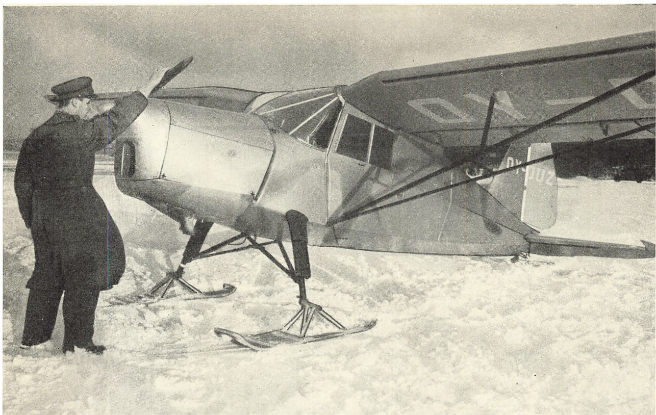
Om vinteren forsynes flyvemaskinerne med skiunderstel, så der kan landes på de tilsneede marker eller på tilfrosne søer.
