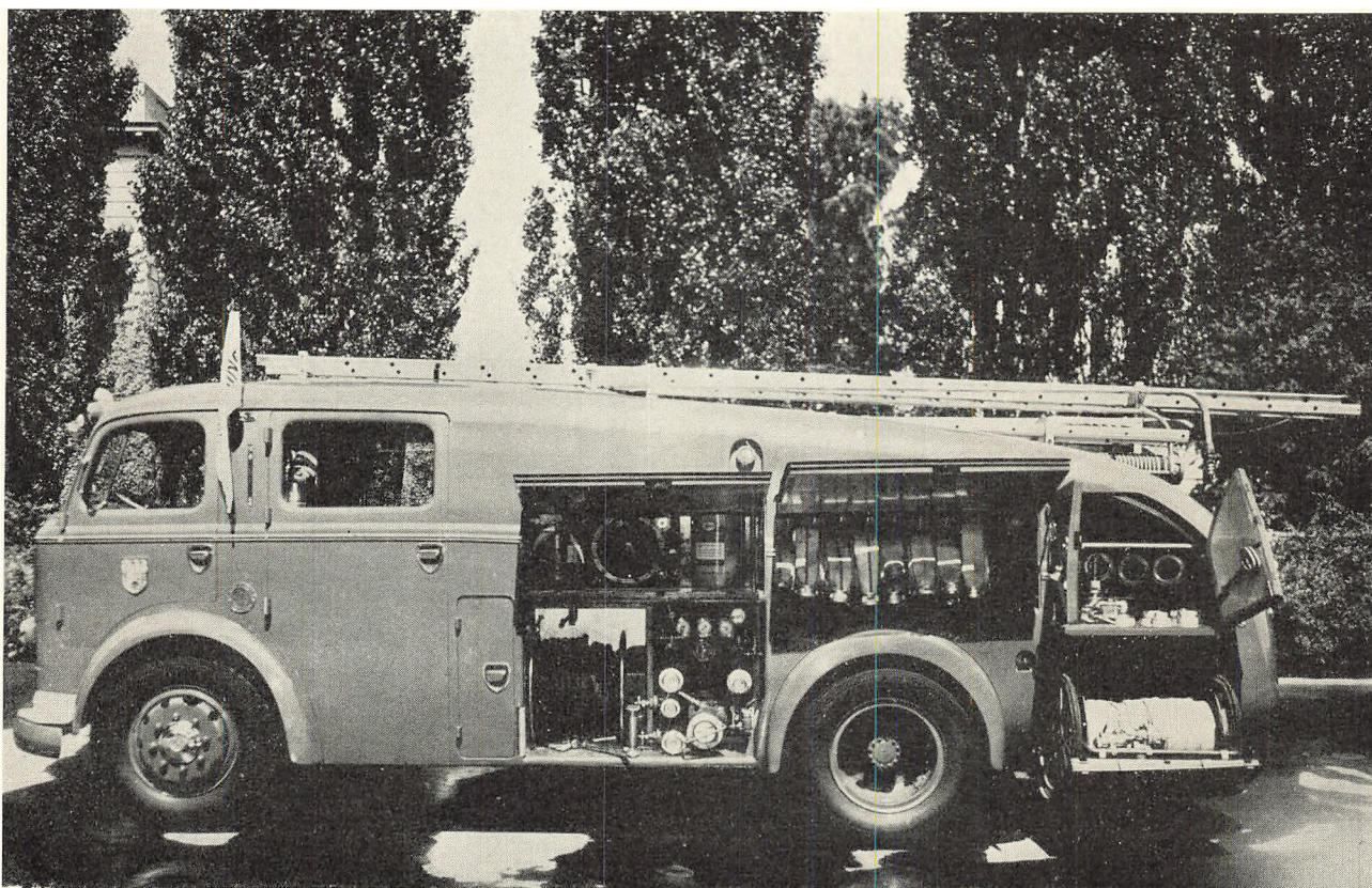
Universalsprøjt fra 1953 forsynet med høj- og lavtrykpumpe, skumanlæg, „vådt-vands“ anlæg, 1500 liter vandtanke samt krybestige, udskydningsstige og italiensk stige.
