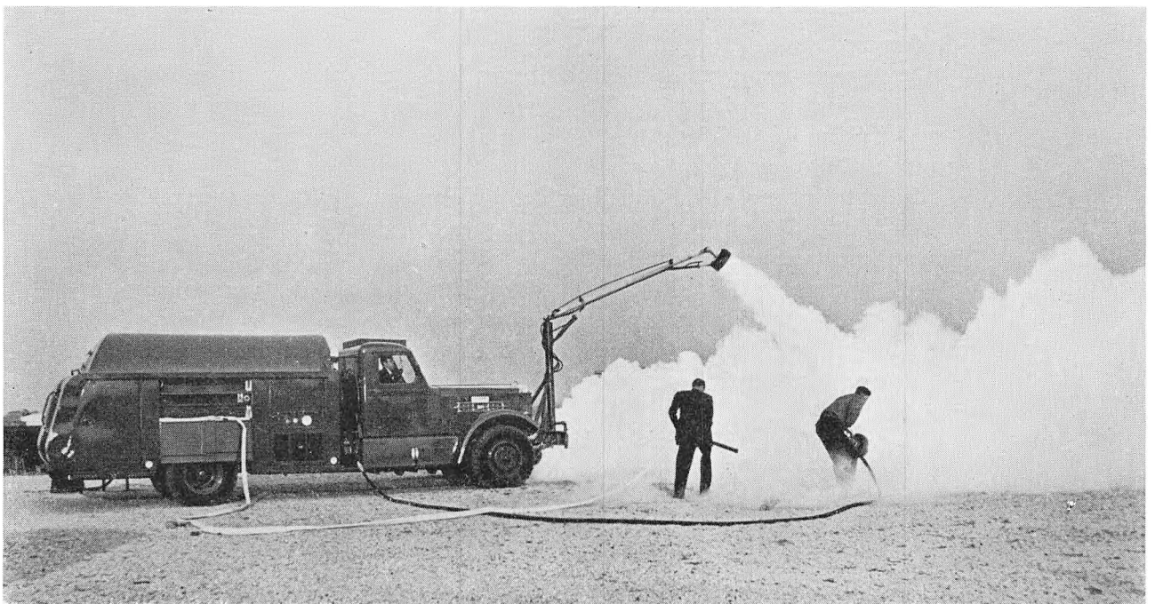
Kulsyre-brandsprojten til brug ved brand i nedstyrkede luftfartøjer medførende flydende kulsyre under tryk. Kulsyren udsprøjtes dels gennem dyser anbragt drejeligt over vognens forparti, dels gennem slanger med tragtformede strålerør. Ved udsprøjningen forvandles den flydende kulsyre til kulsyresne.
