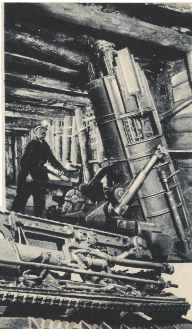
Eine Drehung des Steuerrads genügt, und die Maschine verläßt das Gehäuse, um ins Flöz vorzudringen. Bild unten: Die Maschine ohne Gehäuse
