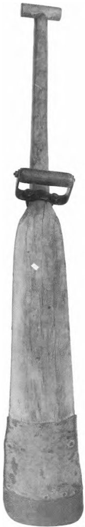
Adskillige daglejere var beskæftiget med at grave de mange grøfter, som skulle til ved afvanding med drænrør af tegl. De gravede med smalle drænspader som denne, der har et langt blad af træ og et jernstykke i spidsen.
