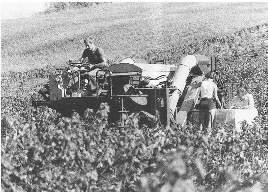
Den specialiserede solbærplukkemaskine kommer omkring mange buske i landet. Det hårde og langvarige håndens arbejde er afløst af en maskine, der klarer hele høsten på et par timer.
