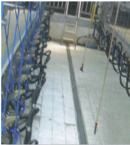
Ny malkestald beses - alle rør er placeret i en kælder under malkegraven
