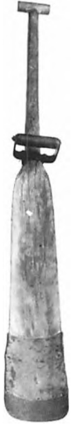
I 1850-erne blev mange marker langs østkysten afvandet med drænrør af tegl, som blev gravet ned ved hjælp af smalle drænsparer som denne på Bov Museum. Willy Goy fot.
