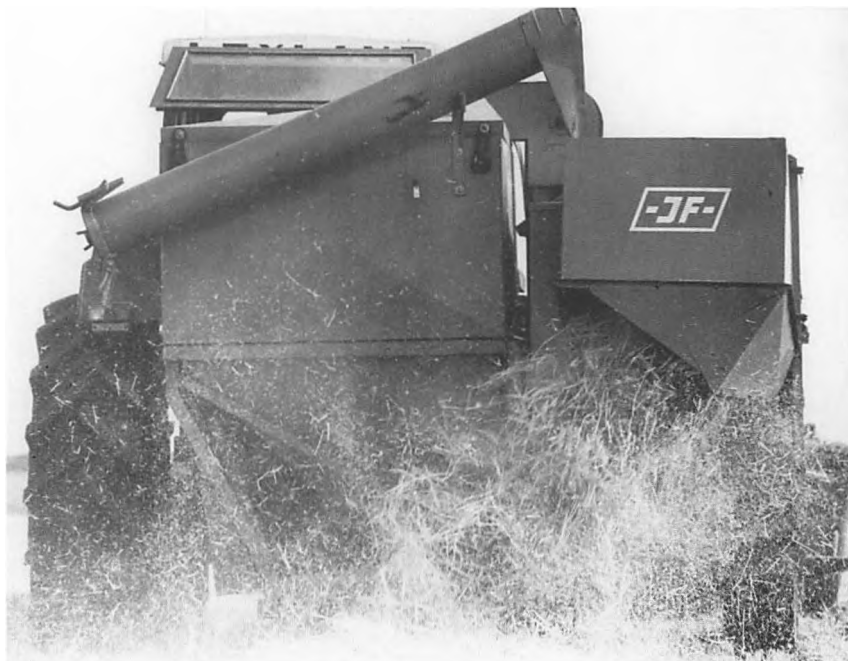
Landsdelens egen maskinfabrik, JF-fabrikken i Sønderborg, fremstillede bugserede mejetærskere, der var ophængt på siden af traktoren. Som de andre bugserede mejetærskere blev de med tiden for små. H. C. Gabelgaard fot. hos JydskeVestkysten.
